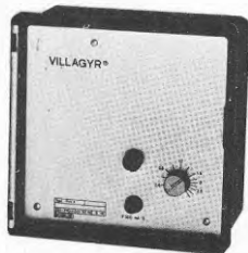
Reglercentral helt elektronisk, styr reglermotorn med ledning av impulser från givarna och klocktermostaten
