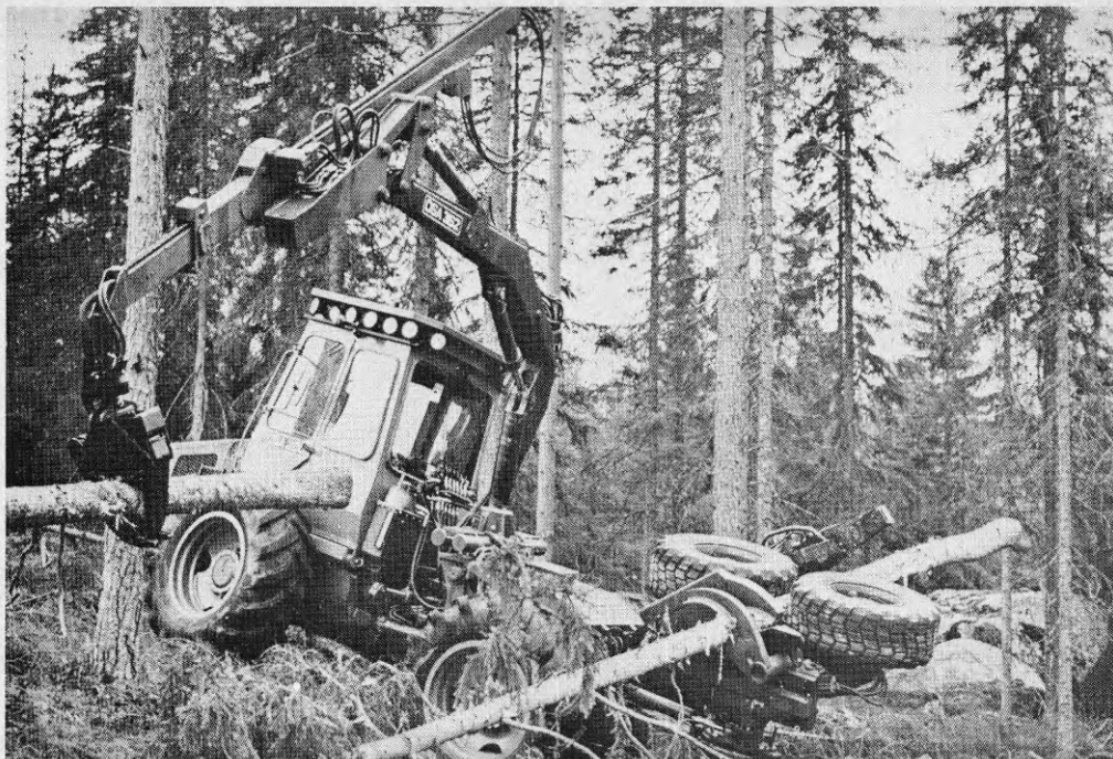
Gallringsprocessor som även utnyttjas i slutavverkningar
