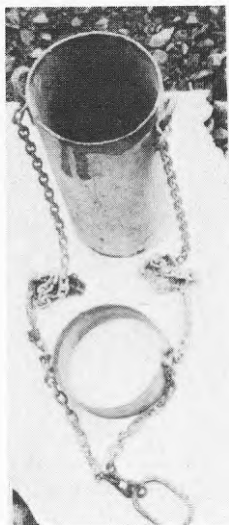
Bild 17. Korg för upptransport av armeringsjärn.
