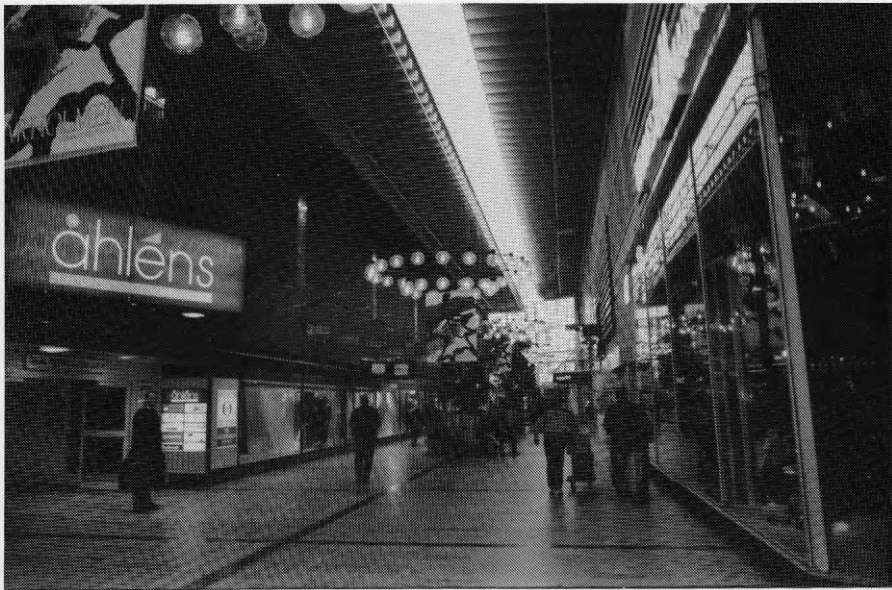
Figur 3.6. Lillholms- och Byholmsgången är 9 m breda och har endast 1,5 m breda glastak 12 m över golv. Dessa gågator har därför mindre dagsljus än Storholmsgatan.
