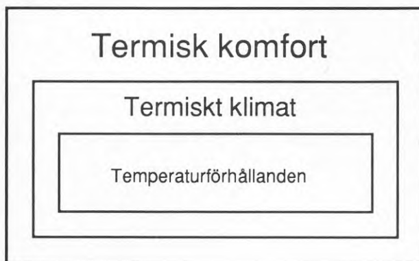
Figur 4.1. Termisk komfort påverkas av såväl det termiska klimatet som av fysisk aktivitet, klädsel och individuella önskemål. Det termiska klimatet påverkas i sin tur av temperaturförhållanden (luft- och yttemperaturer), lufthastighet och luftfuktighet.
