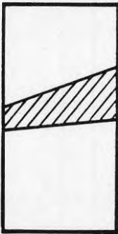
Fig 3. Kvist i tvärsnittet, max 1/3 av tvärsnittsarean.
