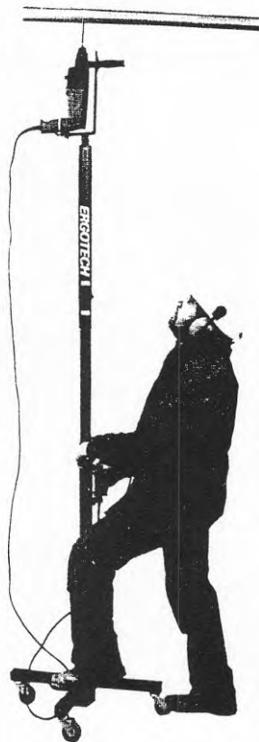
Bild 3: Das „Ergotech“ Bohrstativ, mit dem schwere Bohrhämmer durch eine Gasfeder bis zu einer Höhe von 3,5 m Höhe gefahren werden können.
