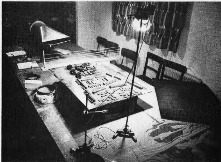
Fig. 11.11. Fläkt, vindprofilgitter och modell vid enkla strömningsförsök.
