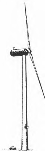
Figur 5.1 Basprojekt 2: 50 m turbin med konade nav och blad av kolfiberkomposit. Generatoreffekt 1 MW.
