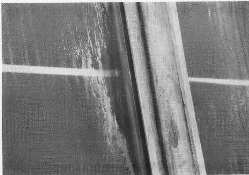
"Outgassing". (Beläggning på insidan av täckskivan).
