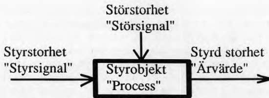
Figur 2.1. Principen för ett öppet styr system.
