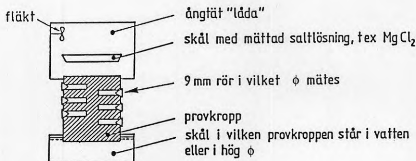
FIG.1 Principskiss av mätupställning
