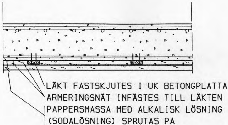
Figur 3.13 Realkalisering
