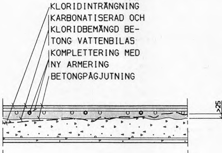
Figur 2.1 Reparation med hjälp av vattenbilning och ersättning med ny betong
