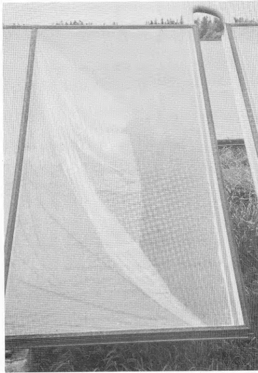
Figur 7.2 På några ställen i det nya fältet har teflonfolien helt rämnat.
