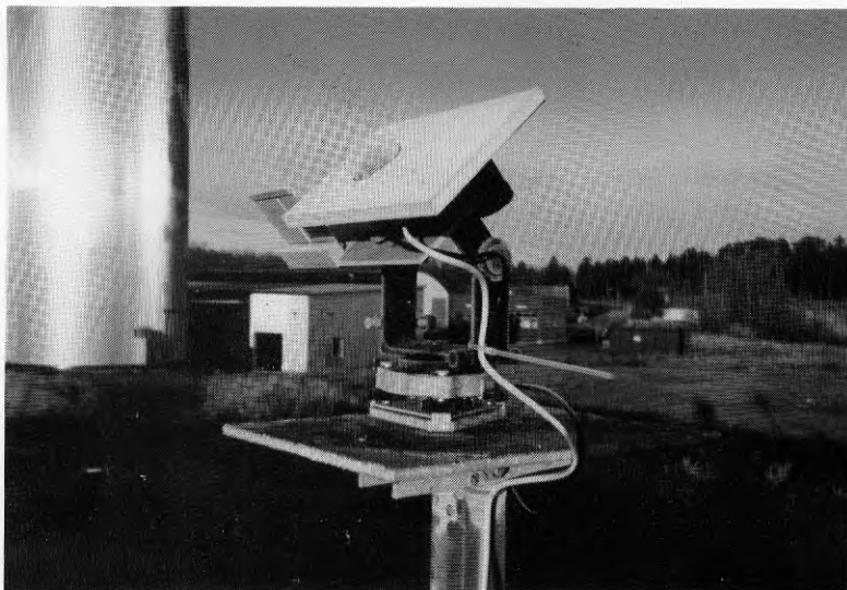
Figur B 1.2 Vid ett tillfälle då fläkten inte fungerade bildades frost på pyranometerens glaskupol.
