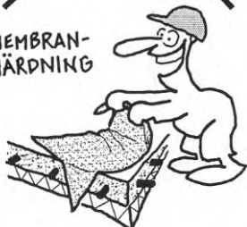
Figur 3.4 Byggnadstekniska åtgärder för att minska innehållet av byggfukt i betongplattan och därmed förkorta uttorkningstiden.
