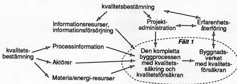
3 Byggprocessen. Kvalitetsbestämning. Erfarenhetsåterföring. (med fält 1 som omfattar kvalitetssäkring och kvalitetsförsäkran)
