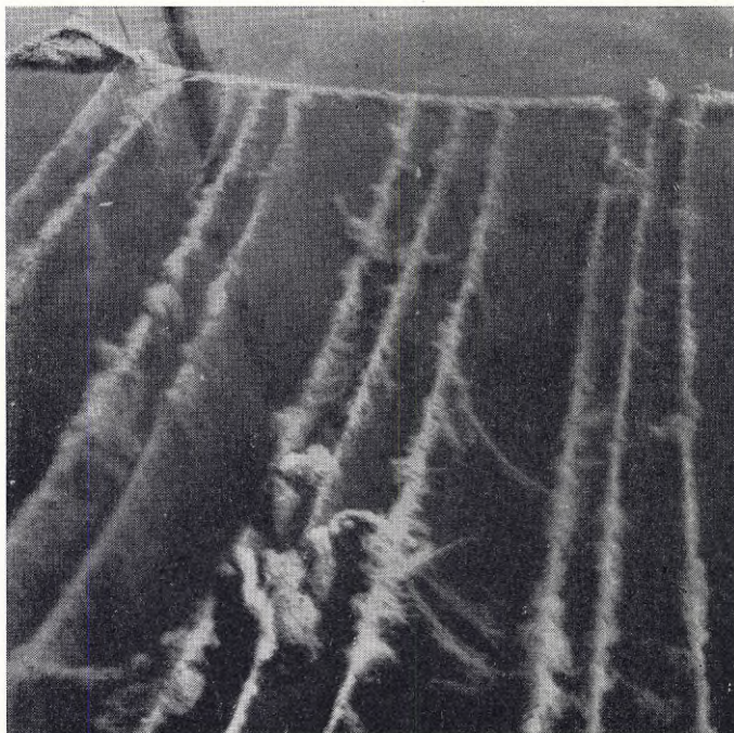
Fig. 5. Provnäten med stark svamp- och algpåväxt.
