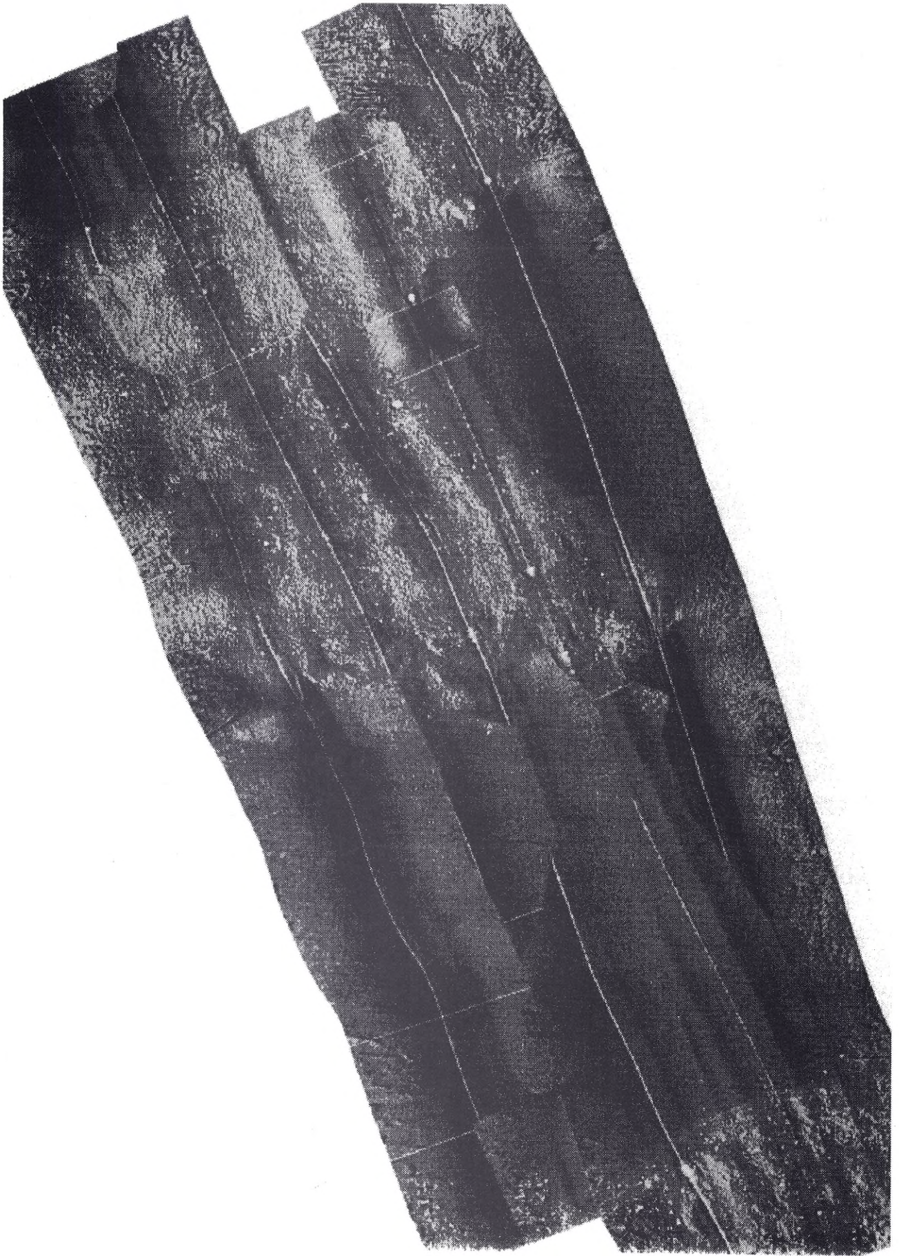
Figur 4: Exempel på utskrifter från sidoscannande sonar
