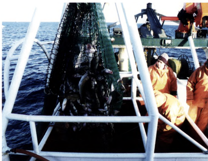
Fig.4.7 a och b. Visar s.k. BACOMA trål. Fyrkantmaskor monteras i taket på trålen. Dessa hålls till skillnad från diagonalmaskorna öppna under fisket och tillåter fisk under minimimått att simma ut ur trålen och därmed undgå att fångas.
