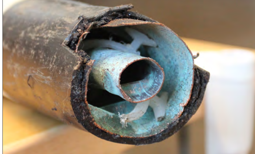
Ovan: Vägledare ansluten till radiolänkutrustning RL 41. Foto: Tony Axelsson
