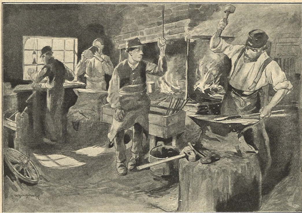
Man hade de båda städen helt nära hvarandra, på hvar sin sida om härden.
