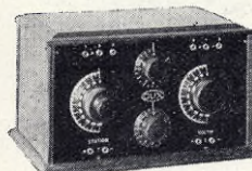
Typ DUX IV. Fyrarörs mottagare med Det. o. tre stegs motståndskopplad lågr.
