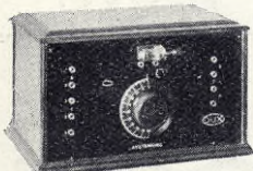
Typ DUX K I. Kristallmottagare med ett effektivt våglängdsområde av 140—2500 met.
