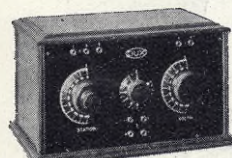
Typ DUX D II. Två rörs mottagare Det. och ett stegs lågr.
