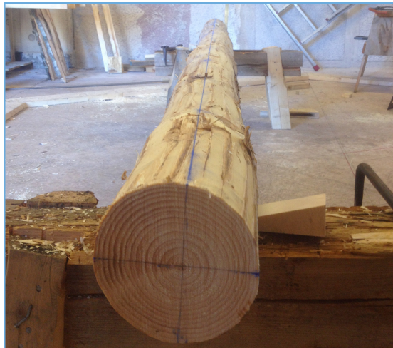
Figur 5 Lod och våg invägda och slagna med snörslå Foto: Torbjörn Einarsson
