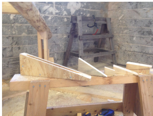
Figur 12 & 13 En av stolpmallarna och de vinkelmallar som användes Foto: Torbjörn Einarsson
