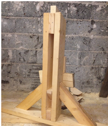
Figur 12 & 13 En av stolpmallarna och de vinkelmallar som användes Foto: Torbjörn Einarsson
