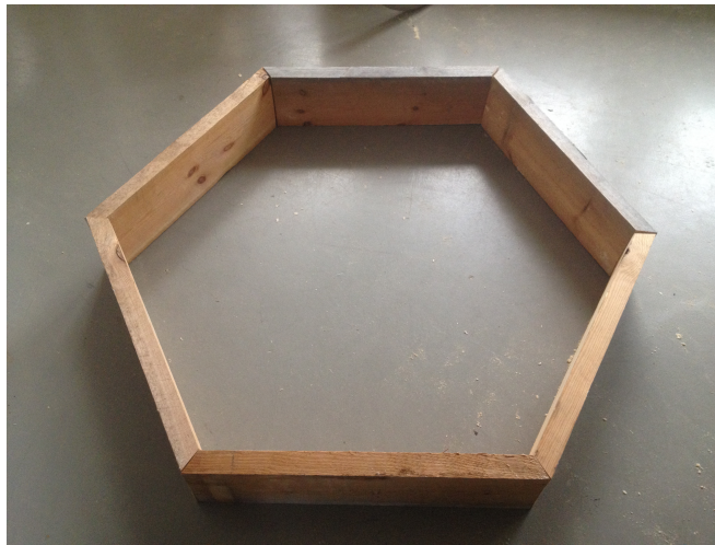
Figur 27 Hexagon i 2" 8" som täcker ändträet i topp Foto: Torbjörn Einarsson
