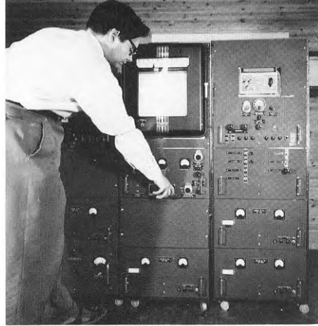
Torleiv Orhaug (ex CTH, E 1954, sedermera vågutbredningsdocent vid CTH och forskningschef på FOA) justerar sin radio-tind-rings-mottagare, med vilken han upptäckte en "rate-step" effekt i norrskens-jonosfären.
