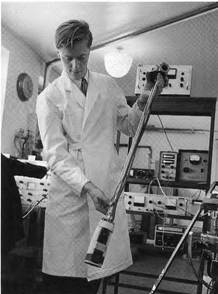
Yngvesson med en "långskaftad" maser för "veckokryostatens" i 25.6 m teleskopet.
