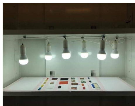
Figur 11 De sex LED-lamporna belyser proverna, uppnålade på kartong, i ljuskåpet.
