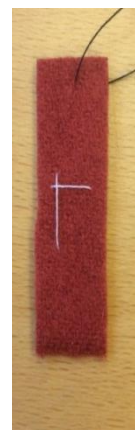
Figur 9 Markering med polyestertråd för mätpunkten.
