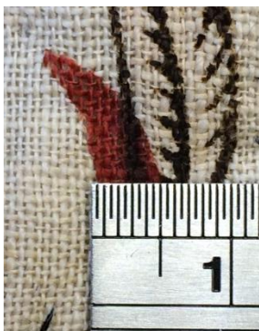
Figur 14 Prov BS (rött) hade en mätyta på endast 2-4 mm (linjalen visar 1 cm).
