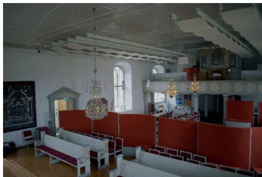
Bild nr. 2: Gudstjänstdelen av rummet betraktat från predikstolen. Fyra bänkar från den tidigare inredningen återstår. Bakom dessa är ett antal lösa stolar placerade. I taket syns de justerbara textilierna som reglerar akustiken. I. Fj. 2017-04-25
