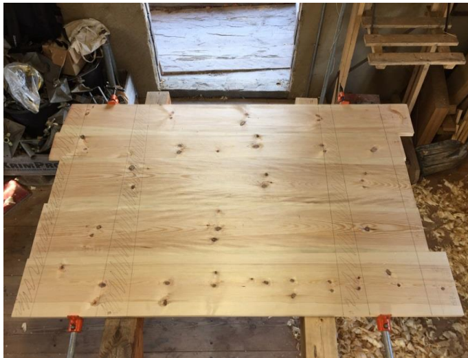
Figur 4. Bredde og høydemål samt øvre og nedre gradspor.
