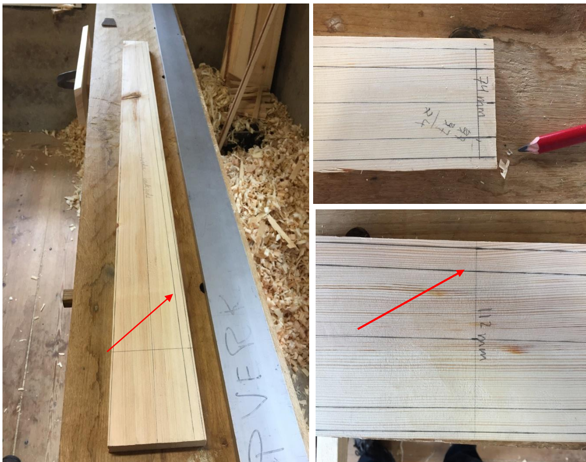
Figur 15. De røde pilene markerer streken der rettholten skal anlegges. Avstanden tilsvarer høyden på gradhøvelens sideanlegg.
