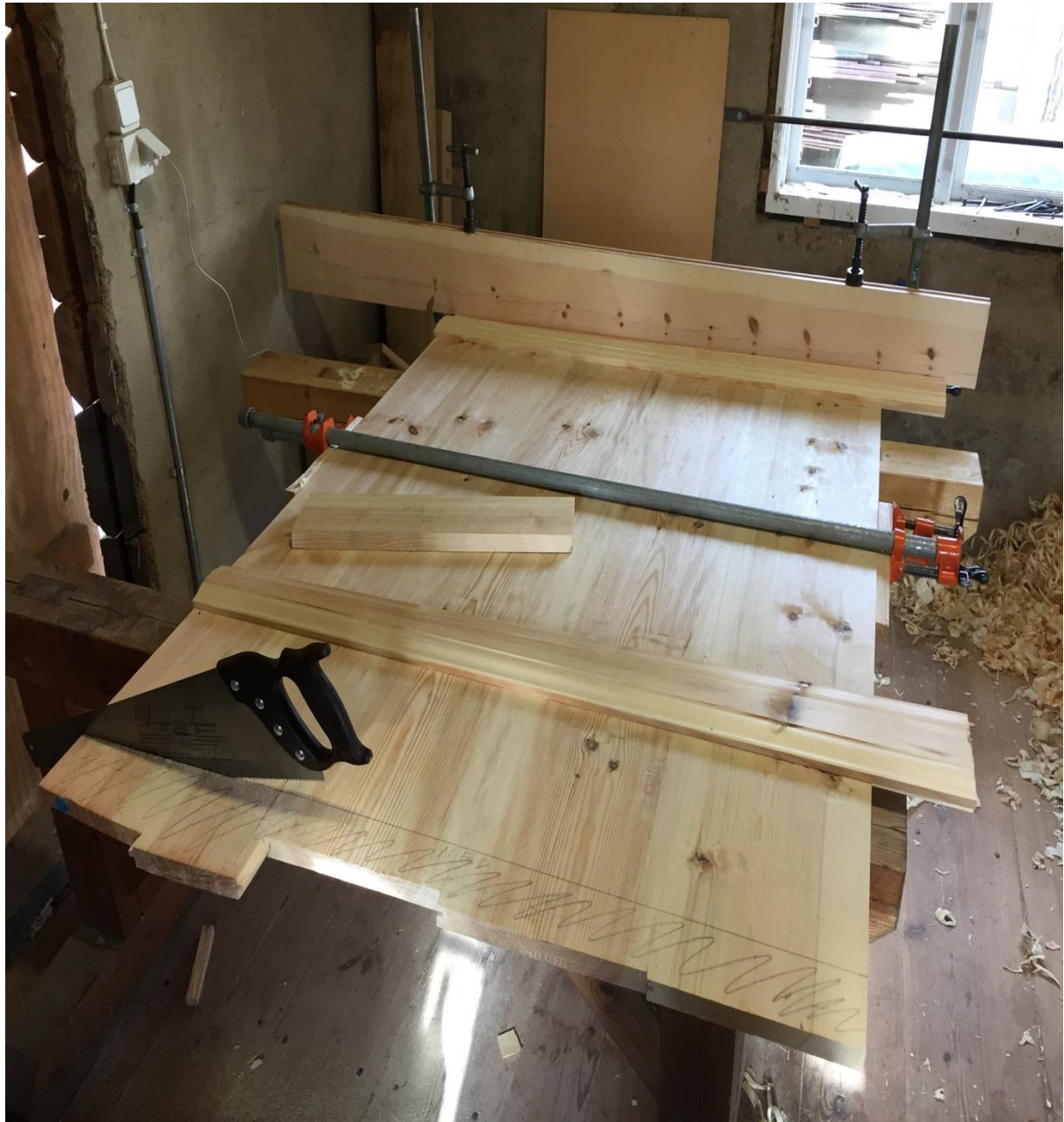
Figur 19. Det totale breddemålet ble justert ved at de to ytterste bordene ble kantet ytterligere. Til slutt drives labankene inn og endene kappes.
