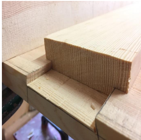
Figur 17. Pilen marker antydning til unøyaktig sagspor. Begge labankene «stoppet» 3 – 4 cm fra enden til tross for hard inndriving.
