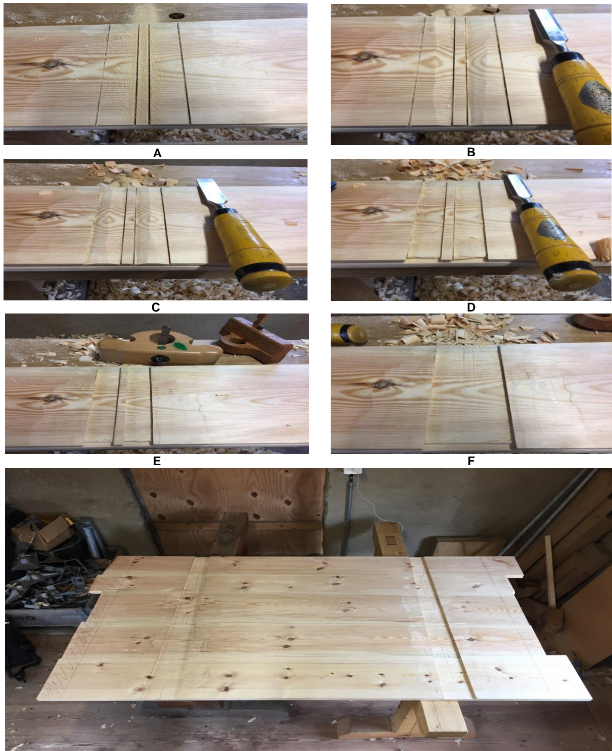
Figur 11. Utstemming av gradspor på hvert bord før sammensetting.
