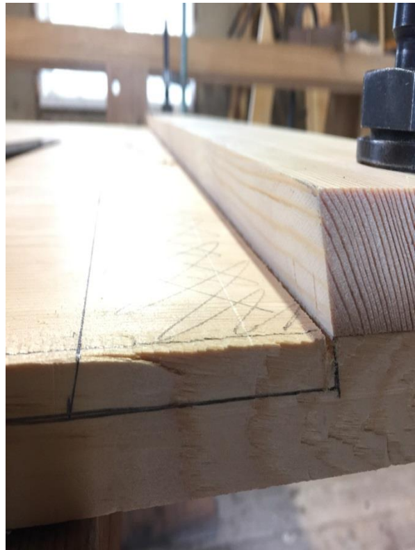
Figur 8. Sporet sages til halv dybde.
