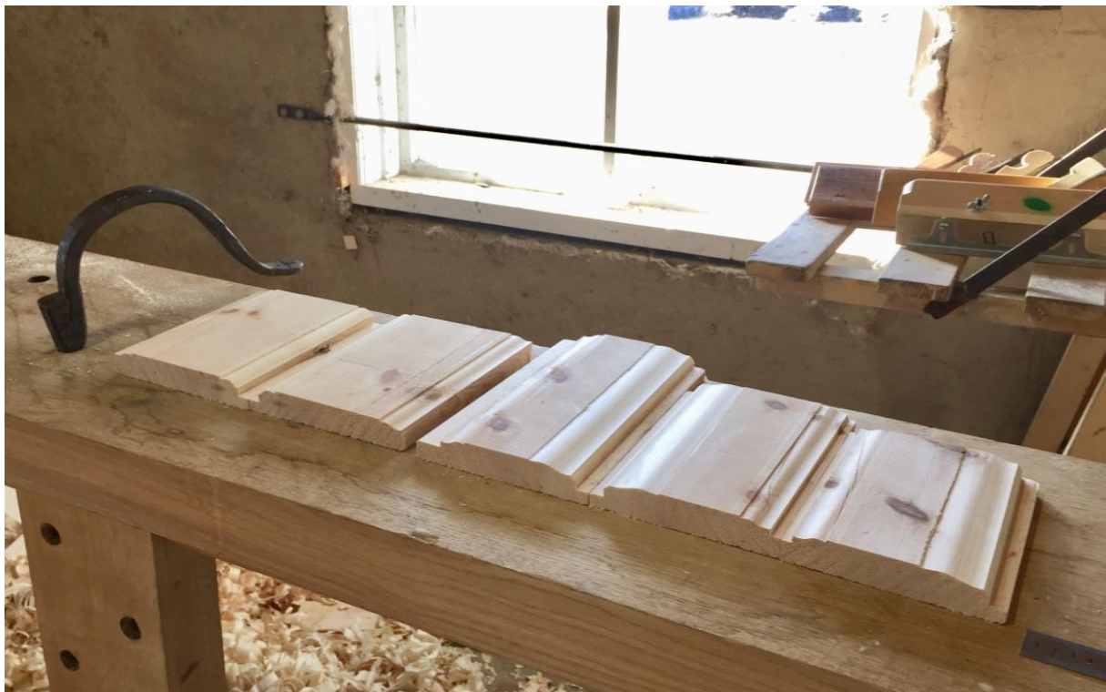
Figur 21. Det ble testet et antall ulike profiler for å se hvem som passet best sammen. Valget falt på bordbitene til venstre i bilde – staff med fals.
