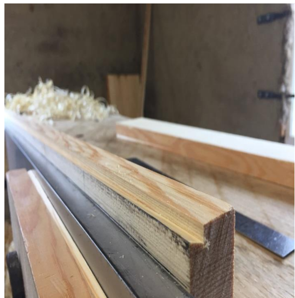
Figur 16. Rettholten anlegges mot tilmålt strek som vist på fig. 15 og spennes fast mot emnet på siden av høvelbenken (A).
