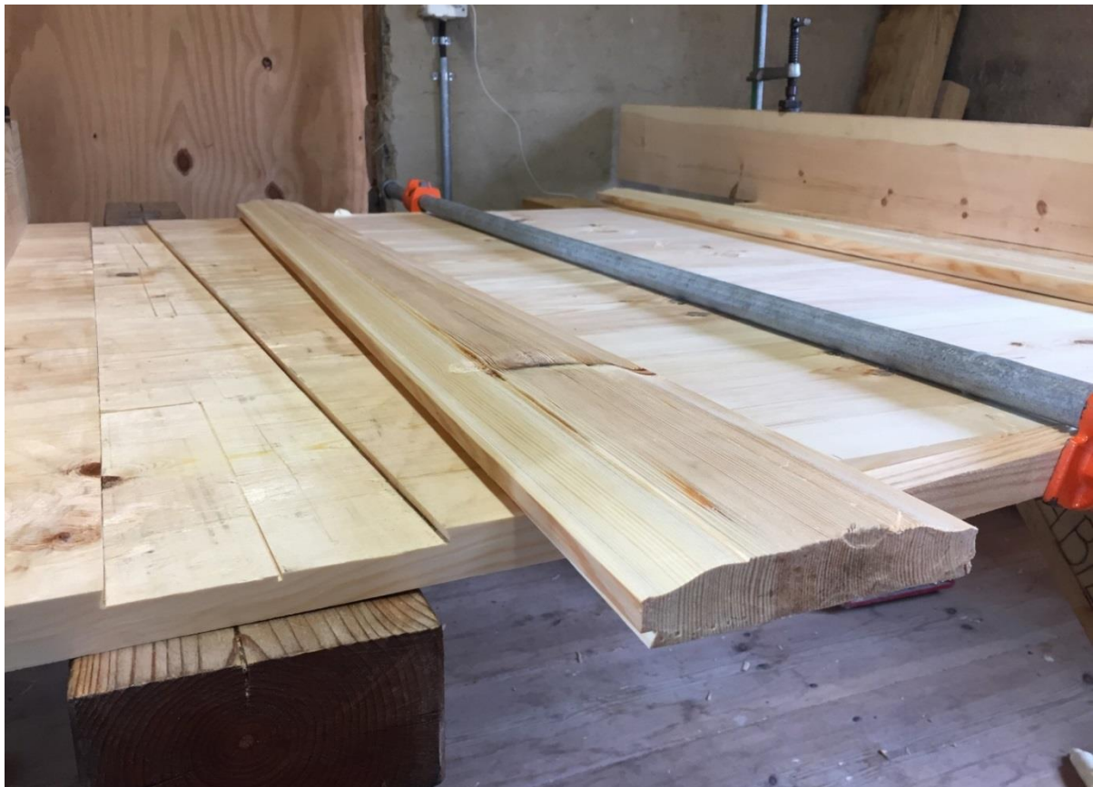
Figur 18. Etter at gradprofilene var korrigeret i henhold til gradsporet, ble labankenes breddemål tilpasset. Til slutt ble det h vlet to brede karnissprofiler p  hver labank.
