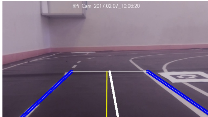
Figur 4.9: Visualiseringen utav kameran mittlinje. Slutsatsen som kan dras ur detta exempel är att fordonet är lite för långt åt vänster i vägbanan.
