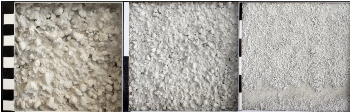
Blandning 43, mellangrov spritputs, moderat flytande, andel vatten 12,2 %.
