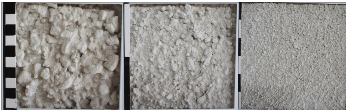
Blandning 40, grov spritputs, andel finsand 32 %, andel ärtgrus: 68 %.
