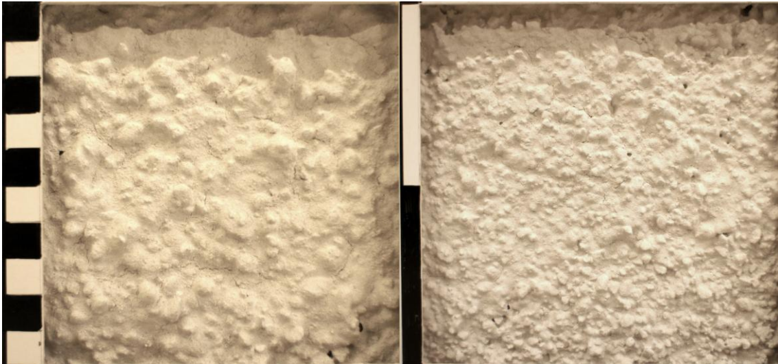
Fig. 29. Blandning 48a löst påslag. I denna puts är gruset till stora delar inbäddat i finbruket.
