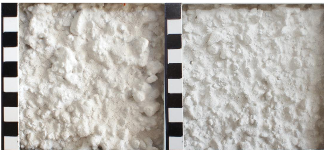
Fig. 11. Vänster och höger bild, grov respektive mellangrov spritputs.
