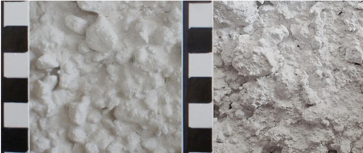
Fig. 6. Till vänster blandning 39 utan 70K och till höger blandning 4 med 30 % 70K i finsanden. Dessa båda är grova spritputser. Utseendet blev dock inte särskilt tilltalande, varför jag uteslöt 70K fortsättningsvis.
