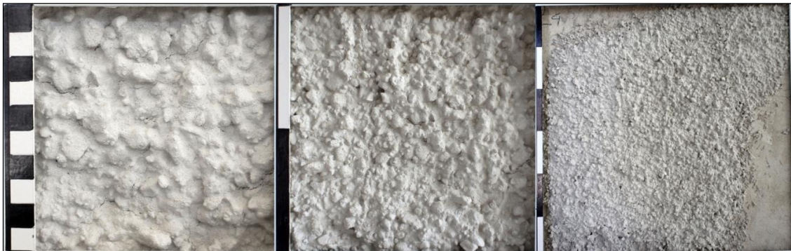
Blandning 42a, grov spritputs, tjockflytande, andel vatten 10,1 %.
