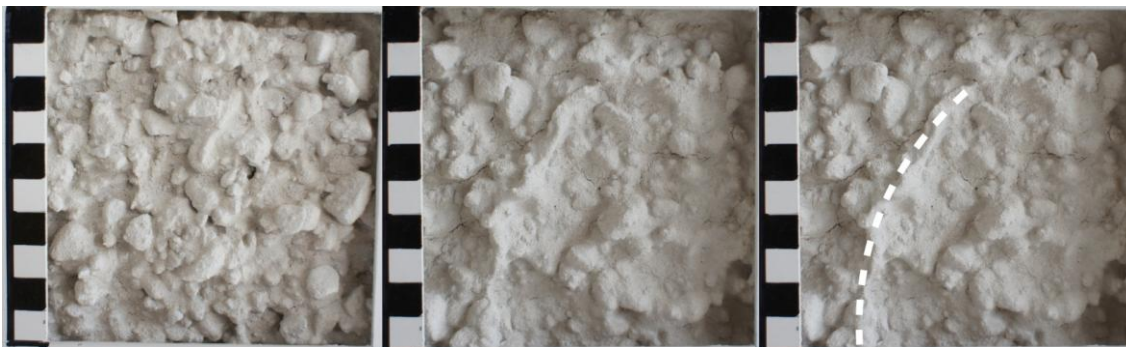
Fig. 20. Vänster: blandning 40. De grova kornen framträder mer. Låg andel finsand gör även att bruket blir "halt" på slevan vilket gör att det är svårare att kontrollera vid påslaget. Mitten och höger: Blandning 40d. Vid påslag uppstår former som den i bild markerats med streckad linje.
