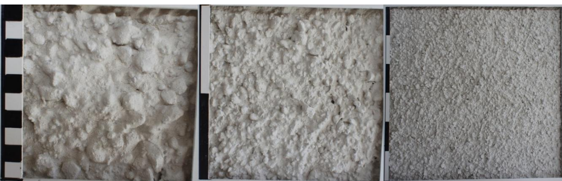
Blandning 40b, grov spritputs, andel finsand 36 %, andel ärtgrus: 64 %.
