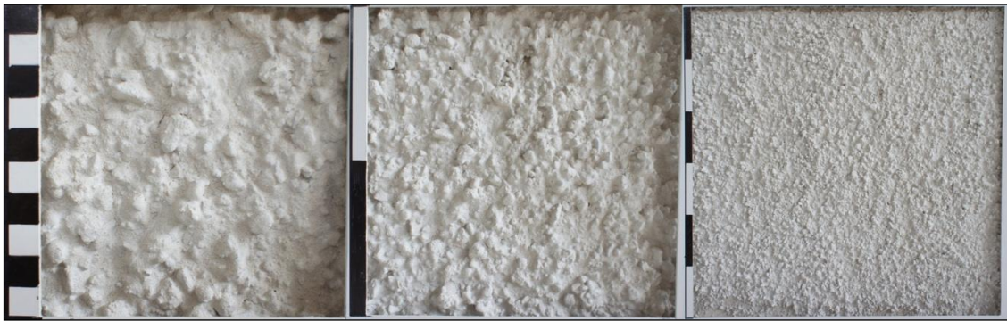
Blandning 41a, mellangrov spritputs, andel finsand 32 %, andel ärtgrus: 68 %.
