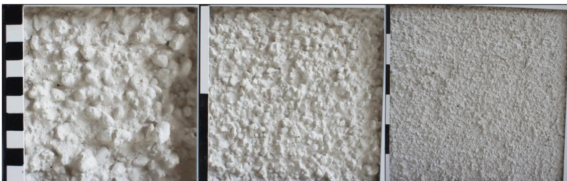
Blandning 41c, mellangrov spritputs, andel finsand 36 %, andel ärtgrus: 64 %.
