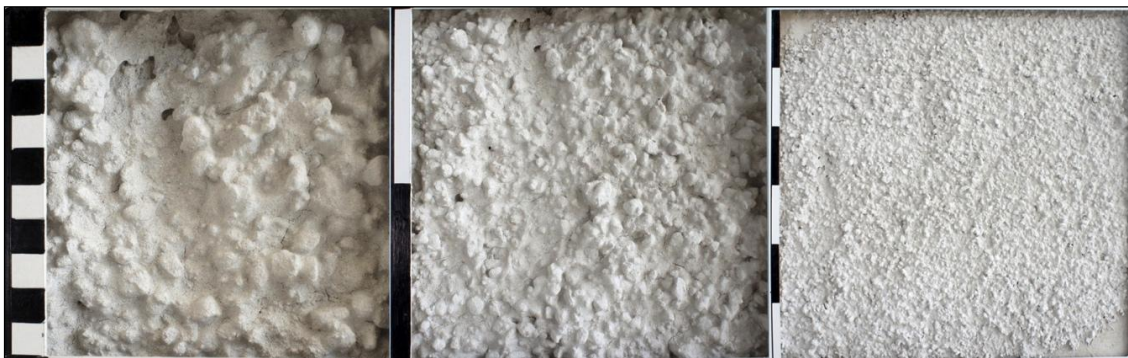
Blandning 43a, mellangrov spritputs, moderat-tunnflytande flytande, andel vatten 12,9 %.
