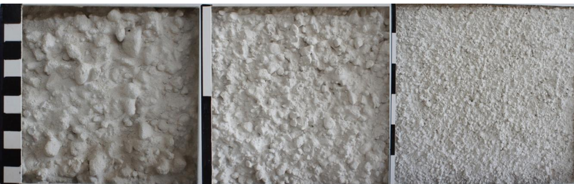
Blandning 40c, grov spritputs, andel finsand 38 %, andel ärtgrus: 62 %.
