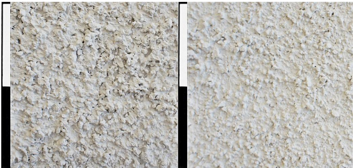
Fig. 25. Blandning 9 och 9a. Vänster putsyta som är slagen emot föregående påslag innehåller fler håligheter än höger bild, där putsen är slagen ifrån föregående påslag.
