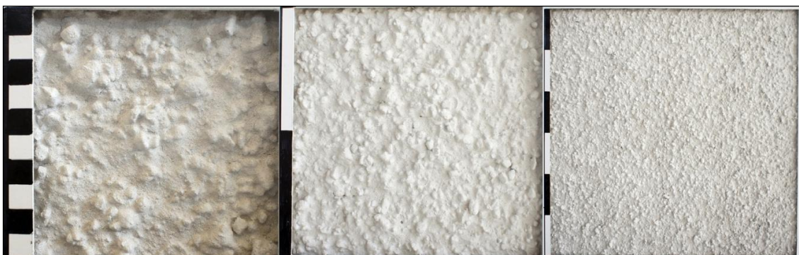
Blandning 43b, mellangrov spritputs, tunnflytande, andel vatten 13,5 %.
