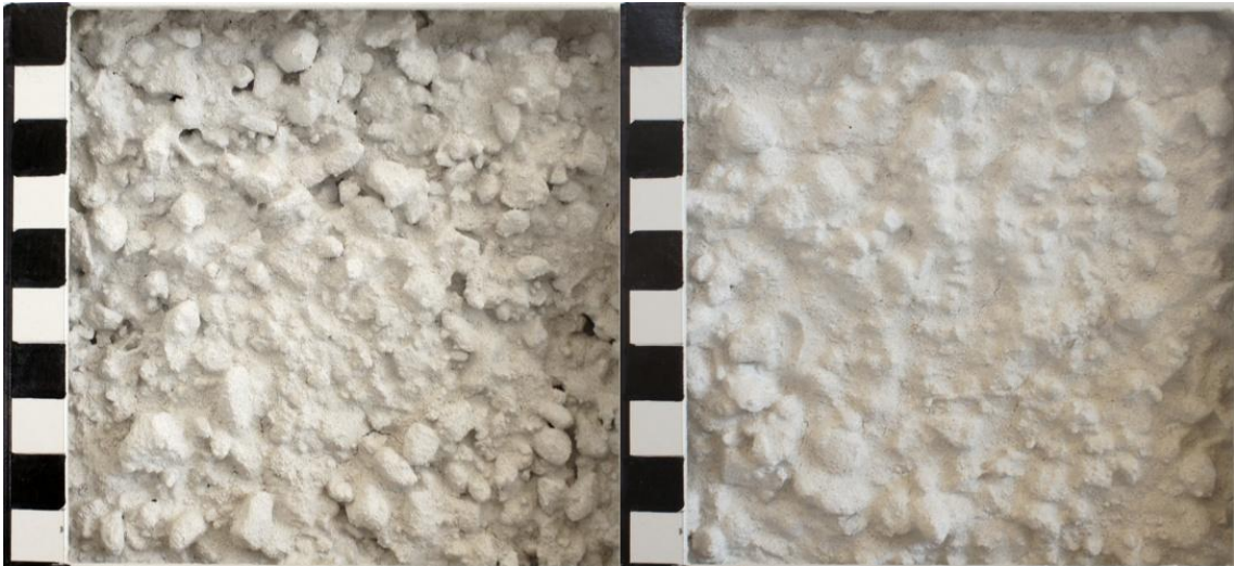
Fig. 17. Blandningarna 43 och 43b. Skillnaderna är stora avseende framförallt förekomst av håligheter, där putsyta 43 slagen med det mer tjockflytande bruket har mycket hål jämfört med 43b, slagen med ett tunnflytande bruk inte har några hål. Det är även stor skillnad på putsernas tjocklek.
