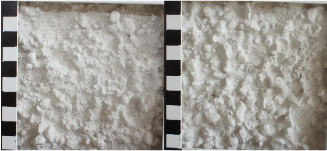
Fig. 23. Vänster: Blandning 41a. De grova kornen framträder, även 1-2 mm framträder synbart mer. Höger: Blandning 41d, där ärtgruset är mer inbäddad i finsanden än i 41a. Vid 38 % finsand börjar bruket vara svårt att slå på utan att oönskade former uppstår, därför görs ingen blandning med 40 %.
