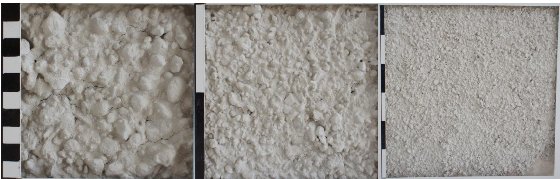
Fig. 30. Blandning 38, grov spritputs löst påslag. Ett löst påslag är en förutsättning om de grova kornen inte skall studsas av. Detta bruk var moderat flytande, 11,0 % vatten. En grov puts med mer tjockflytande konsistens skulle troligtvis kunna slås på hårdare.
