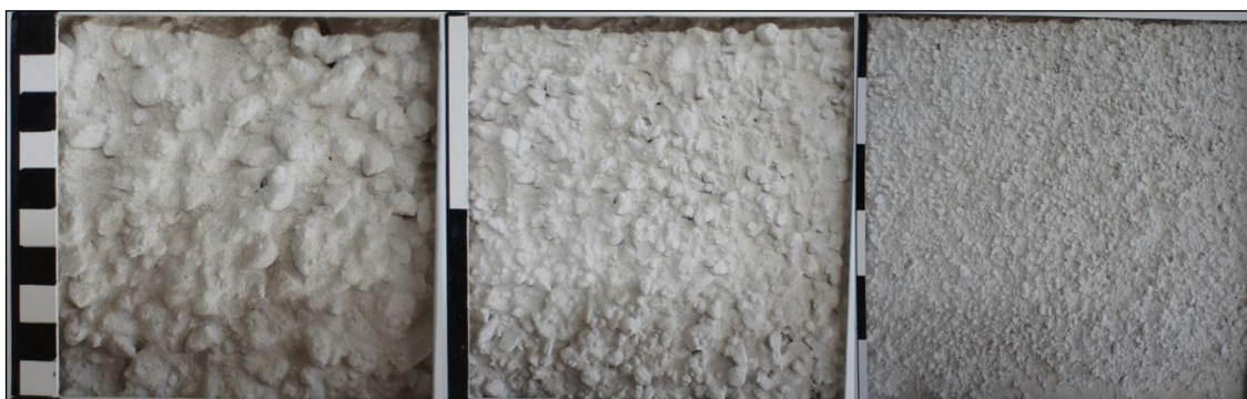
Blandning 40a, grov spritputs, andel finsand 34 %, andel ärtgrus: 66 %.
