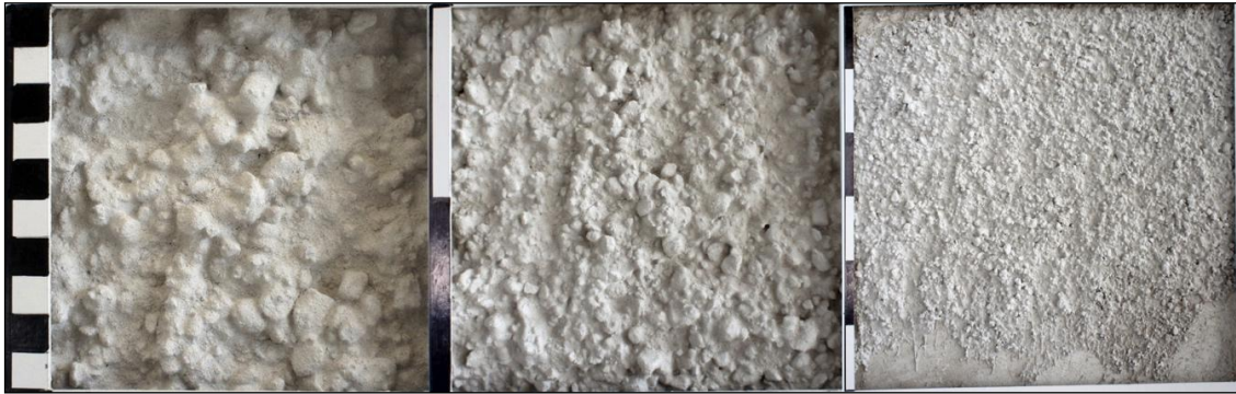
Blandning 42c, grov spritputs, moderat flytande, andel vatten 12,3 %.
