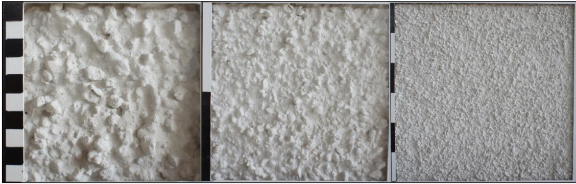
Blandning 41d, mellangrov spritputs, andel finsand 38 %, andel ärtgrus: 62 %.
