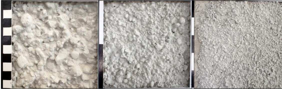
Blandning 42, grov spritputs, tjockflytande, andel vatten 9,8 %.
