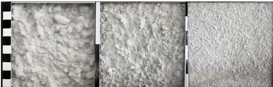
Blandning 42b, grov spritputs, moderatflytande, andel vatten 11,0 %.
