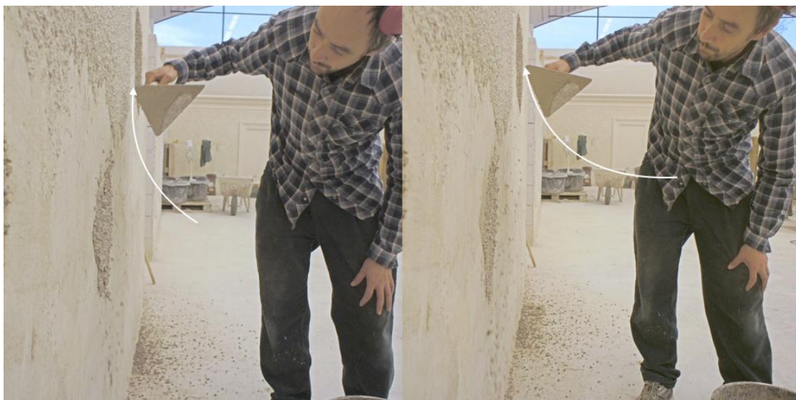
Fig. 14. Löst respektive hårt påslag. Bilderna är tagna ur bildserier där hela påslagssekvensen finns med. På så vis har ansatsens längd kunnat tas fram (markerade med vita pilar). Ansatsernas längd skiljer sig åt, likaså kan man utläsa att kroppsrorelserna skiljer sig från varandra. I den högra bilden är kroppen mer i rörelse än i den vänstra bilden.
