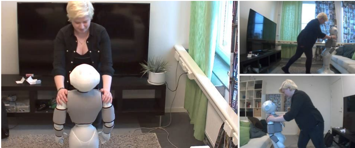
Figur 4. Ett exempel på experimentets upplägg där deltagaren interagerar med Pepper i Usability Lab. Deltagaren interagerar med roboten genom att röra vänster och höger axel för att förmedla en av emotionerna. Bilderna är sammansatta genom annoteringsprogrammet ELAN.
