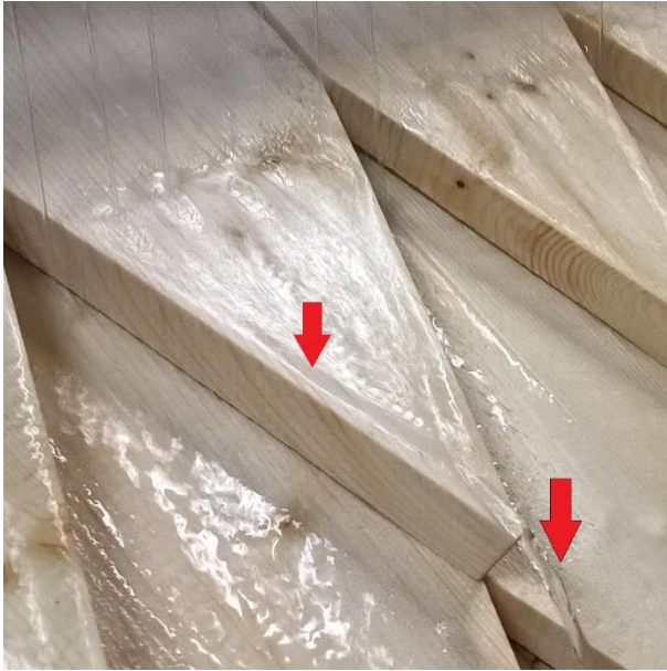
Figur 85 Vattnet följde de spetsiga spånens kanter och centrerades i en stråle ute i spetsen, se pilar.
