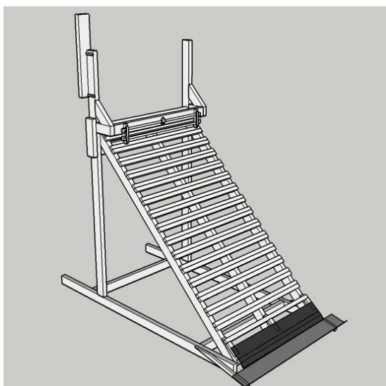
Figur 36 Stommen med 45° lutning till provytorna. Spånen monterades på läkt.
