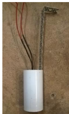
Figur 73 Nivåströmbrytare i skarvmuff. Samma princip för monteringen tillämpades i vattenbehållaren.
