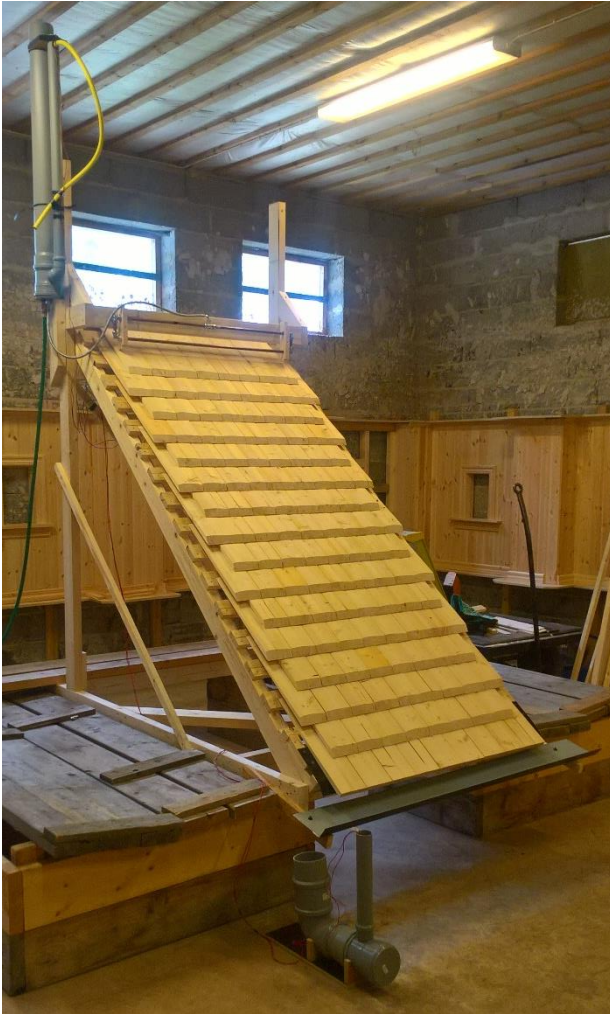
Figur 81 Stomme redo för mätning av vattenavrinningens effektivitet på rakt spån med fas.
