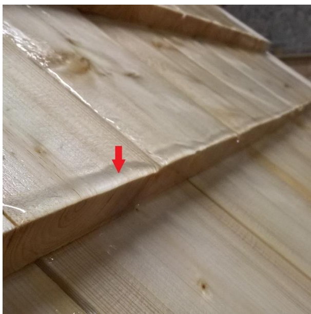
Figur 83 Pilen markerar vågen som uppstod vid kanten på de raka spånen.
