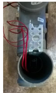
Figur 75 Nivåströmbrytare nedsänkt i röret. Djupet för nedsänkningen begränsas av hålbändet som böjts i en 90° vinkel.
