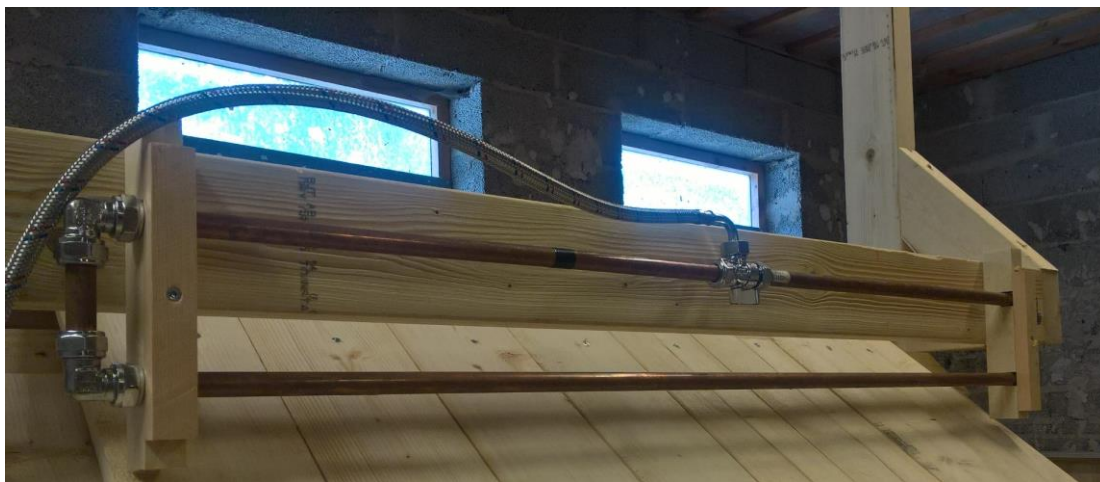
Figur 78 Spridningsrampen ansluten med en flexibelslang till vattenbehållaren. Med kranen i centrum på övre röret startades vattenflödet under experimenten.
