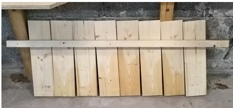
Figur 52 En av de övre läkterna med 8st spån monterade efter avslutat test.
