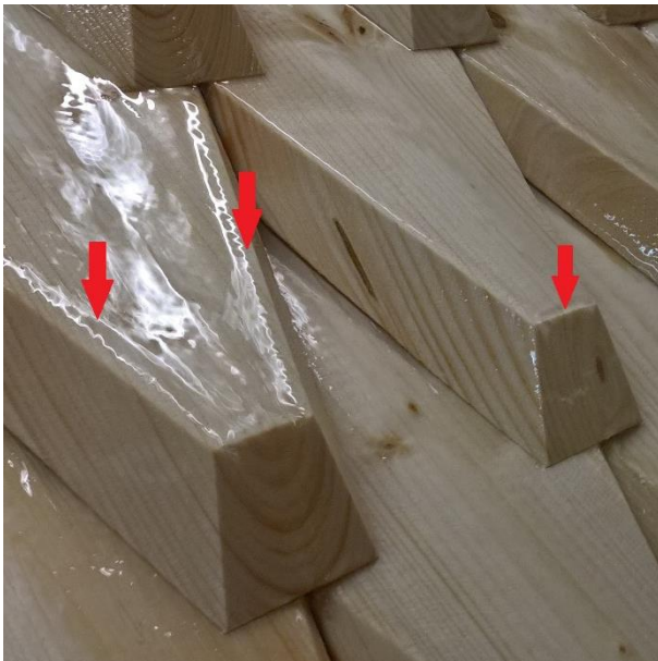
Figur 87 Näbbspånen hade flest kanter och det uppstod därmed också flest vågor på dessa
