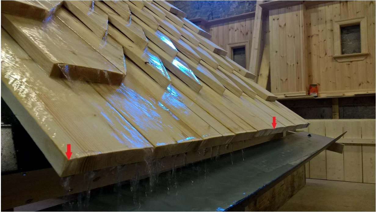
Figur 89 Diagonalens ledande effekt på vattnet resulterade i att det endast rann vatten på 5 av 9 spån vid provytans slut. Pilarna markerar början och slut på de 5 spånens utbredning. Vattenflödets intensitet var som högst på provytans vänstra del.
