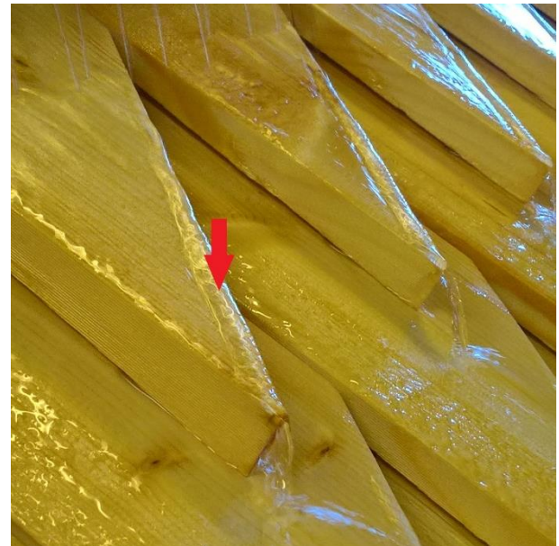
Figur 88 Diagonalspånens diagonal bromsade in vattnet och ledde det ut i spetsen där det centrerades till en stråle riktad lite till vänster i bild.
