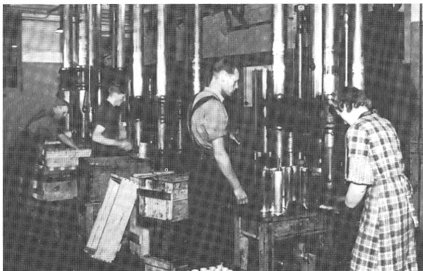
Strypning och dragning av patronhylsor vid ammunitionsfabriken i Marieberg i juni 1940 (Fst pressdetalj).
