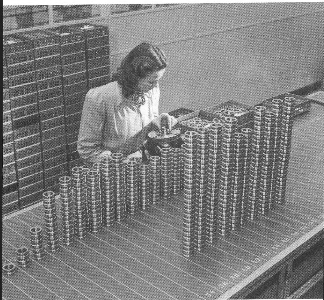
Mätning av spårdiametern på innerringar till enradiga kullager, SKF-Göteborg.
