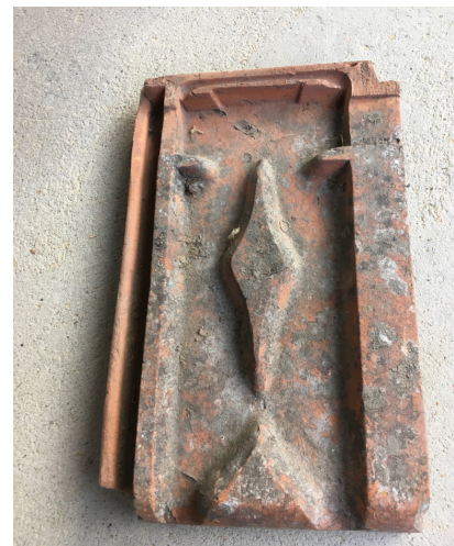
Figur 2.6. Formpressat och falsat tegel. Just denna variant kallas hjärtegel.
