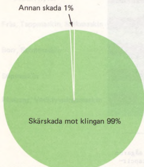
Figur V:3 Arbetsolycksfall med skivningsmaskin fördelade efter skadetyp, år 1979. Arbetstagarare
