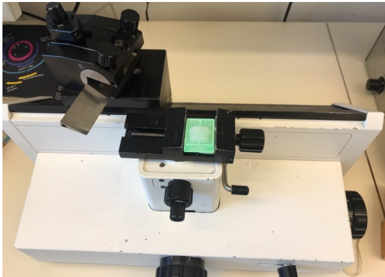
Figur 16. Bilden visar den sladmikrotom vi använt för snittning av klotsen med den paraffininbäddade fibern.
