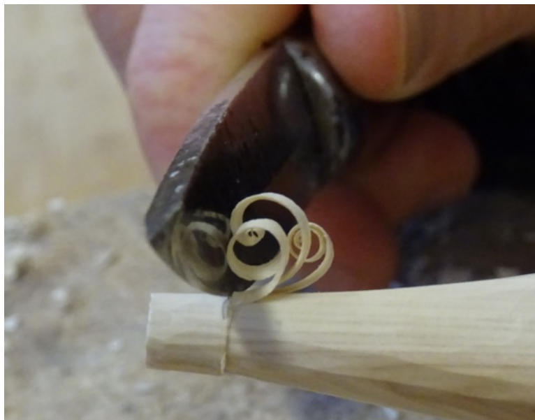
Figur 24 Detaljbild av hur halsen täljs. Räfspinnen är tillverkad enligt Bringéus beskrivning. Foto: Love Brolund
