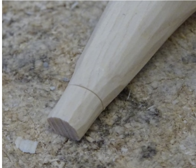
Figur 23 Detaljbild av räfspinne där en skåra för knoppen gjorts. Räfspinnen är tillverkad enligt Bringéus beskrivning.
