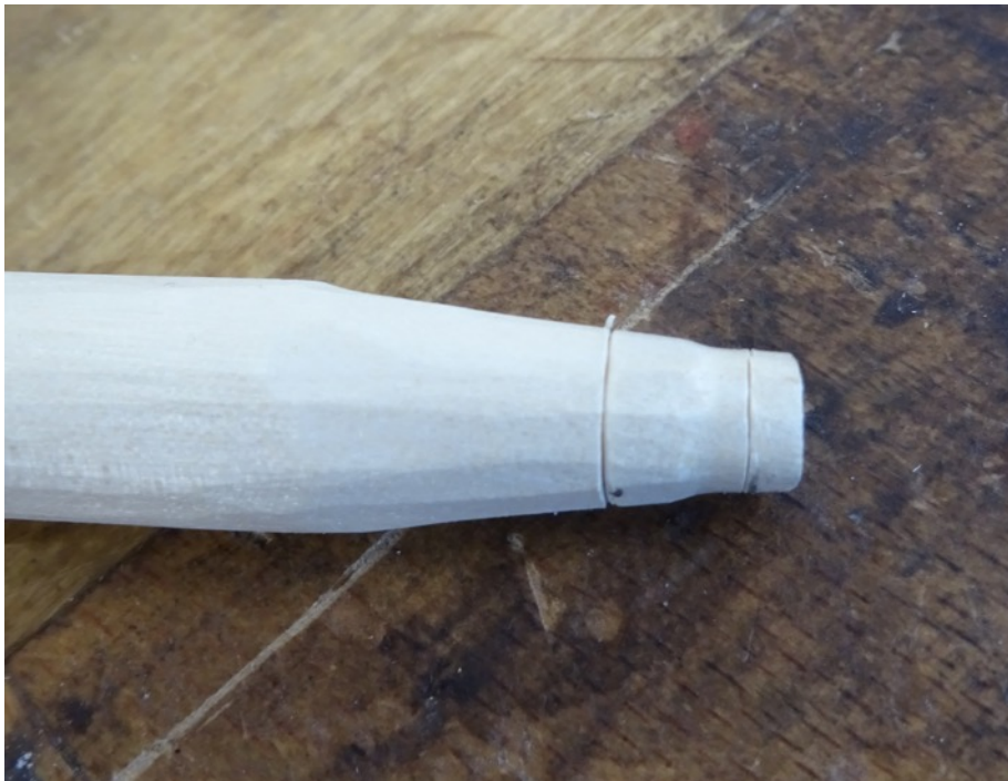
Figur 20 Detaljbild på räfspinne där knoppen markerats enligt metoden från Övre Dalarnes bondekultur .
