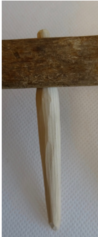
Figur 21 Räfspinne tillverkad efter Sven-Olov Larssons metod.
