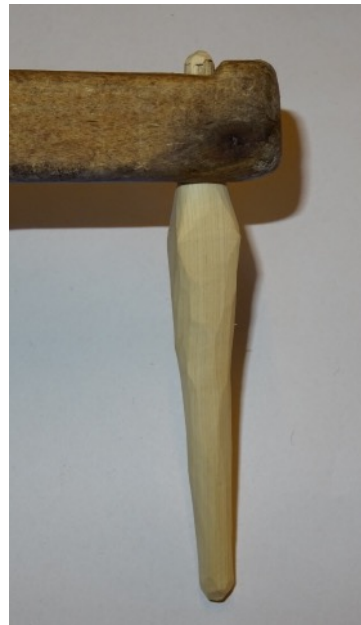
Figur 17 Räfs-pinne tillverkad efter Bringéus beskrivning.
