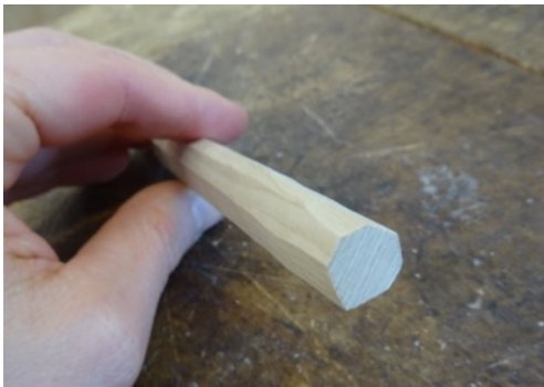
Figur 18 Ämne till räfspinne där tre av fyra hörn fasats av för att tälja ämnet runt.
