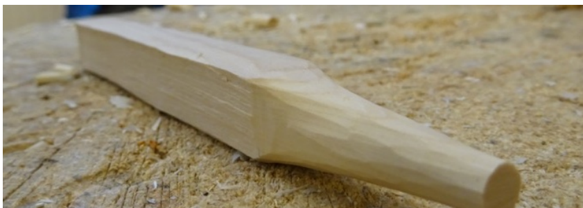
Figur 22 Räfsinneämne där ena änden täljts konisk. Räfsinnen är tillverkad enligt Bringéus beskrivning.
