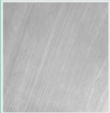
Betad, omålade varmförzinkade moderna plåtar.
