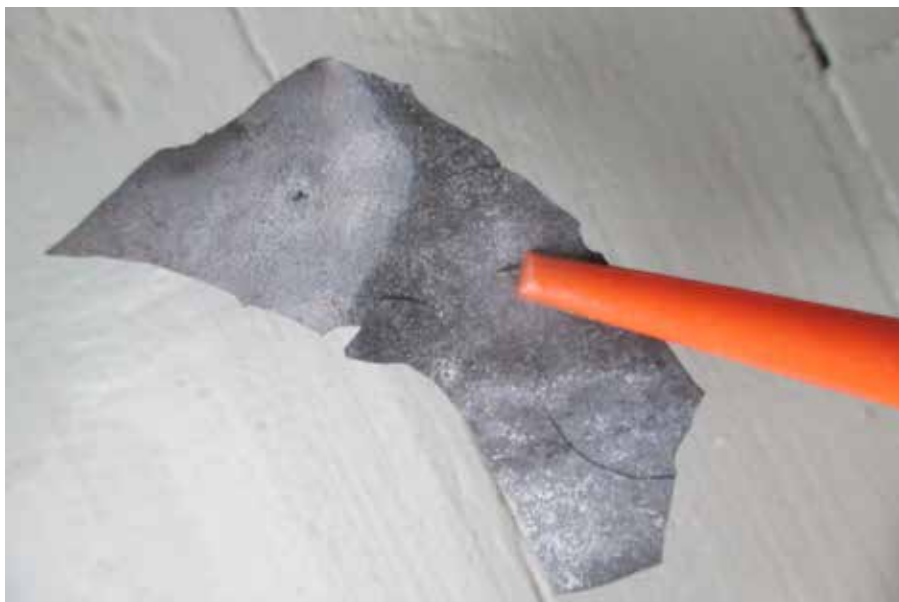
Figur 5.7. Typiskt för flagande färgskikt är att färgflagorna har vita kristallina partiklar på undersidan, från gränssytan mellan zink och grundfärg. Man kan inte visuellt avgöra om det är fråga om förtvålning eller underfilmskorrosion och utan att använda naturvetenskapliga analysmetoder. För att fastställa om partiklarna är oorganiska eller organiska (eller både och) bör de analyseras med metoder som t.ex. Raman, FTIR, XRD eller andra ytkänsliga spektroskopiska metoder som kan skilja på organiska och oorganiska föreningar. Det har inte funnits utrymme i nuvarande studie att undersöka detta.
