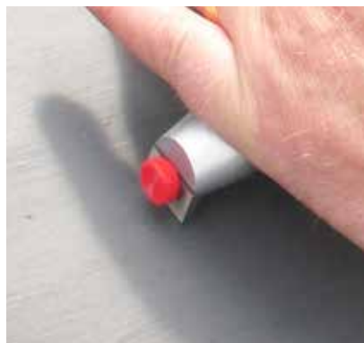
Figur 4.32. och 4.33. Gitterritts, förstoringsglas, borste och tejp att använda när skicket på äldre bemålning ska undersökas. Till höger dras gitterritsen över äldre bemålning. Fler bilder finns på nästa sida.
