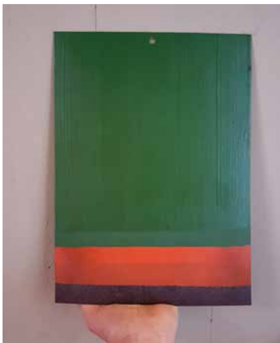
Figur 4.28. Exempel på referensprov. På referensplåtar kan man mäta skikt-tjocklekar och de bör sparas i händelse av problem med taket.
