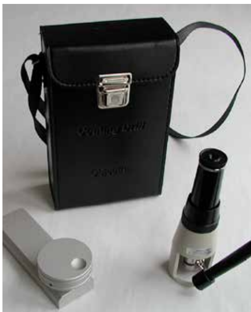
Figur 4.43. En så kallad "coating drill" med vilken man borrar ett koniskt hål där man kan utläsa total skiktjocklek, antal lager och tjockleken hos varje lager, samt kulör.
