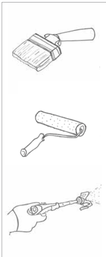
Figur 3.49. De vanligaste metoderna att applicera målarfärg är med pensel, roller eller spruta.
