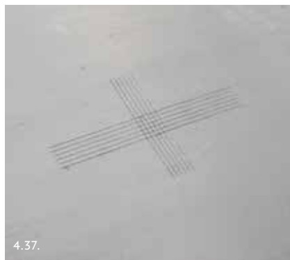
Figur 4.35.-4.38. Gitterrittsmetod med tejp för att kontrollera vidhäftning på rengjord yta.
