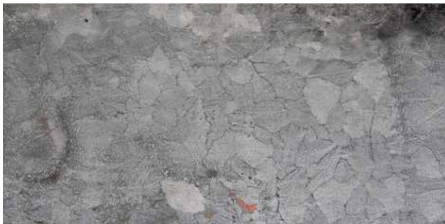
Figur 5.5. Gammal varmförzinkad yta med zinkpatina och rester av färgskikt. Kornen är 0,5-1 cm stora.
