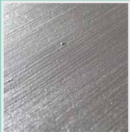
Plan plåt målad med pansarfärg (kvarttungstandolja).
