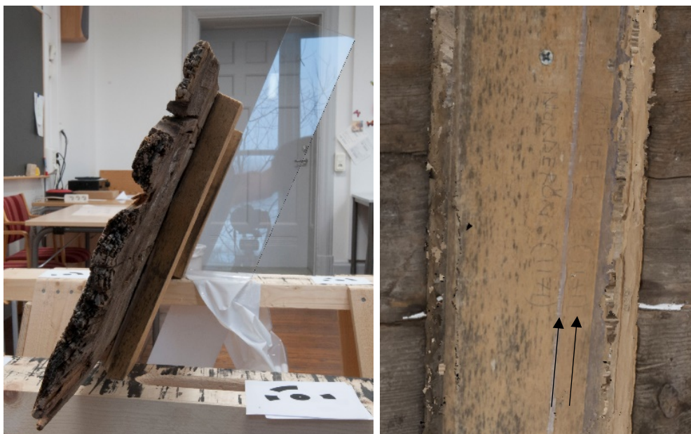
Figuren ovan till vänster visar tillvägagångssättet med den lutande plexiglasskivan T.h. visar 3D modellen med textur och inbakad reflektion av text, samt ett tunt grått streck från plexiglasskivan
