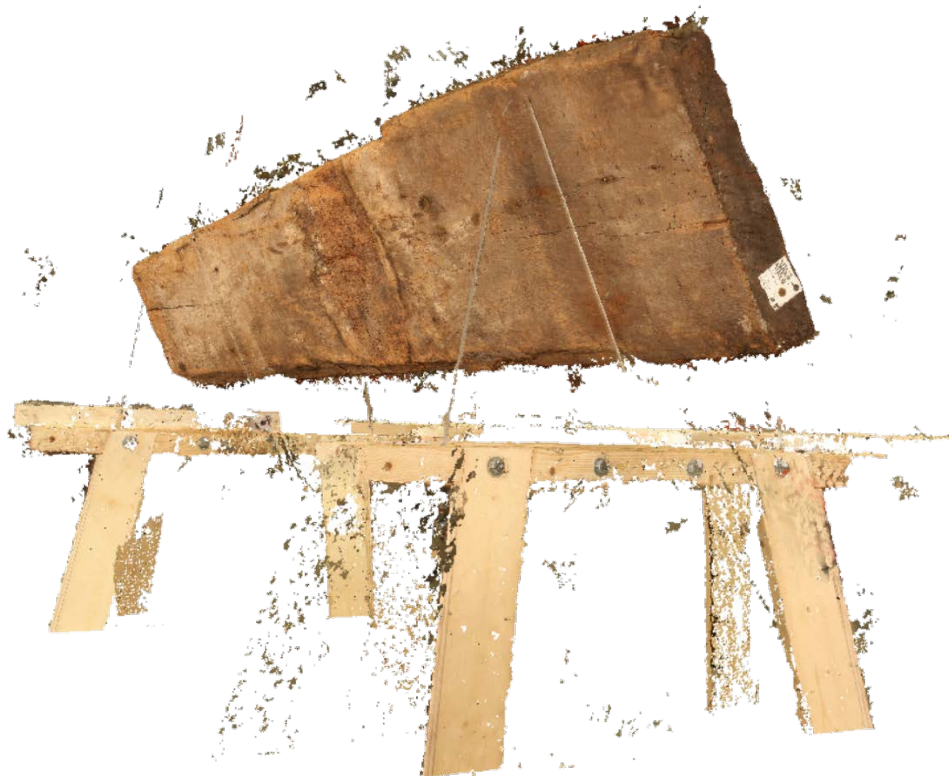
Punktmolnet (ej städad) ovan visar effekten av transparenta upplag, föremålet svävar över bockarna. Den diagonala grå randen efter plexiglasskivan som är synlig blir senare inbakad i modell och textur. De fritt svävande klustren av punkter utgörs av "skräp" och rensas bort manuellt, förekomsten kan i vissa fall minskas genom att använda fler och bättre foton till modellen
