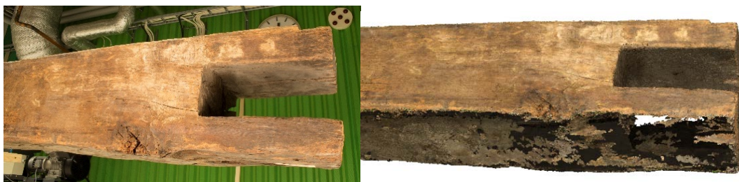
Figuren ovan t.v. visar ett foto som togs ”snett underifrån”, det är i efterhand tydligt att bilden inte togs tillräckligt ”snett underifrån” då den undre ytan knappt är synlig, detta resulterar i hål i och deformationer i punktmolnet ovan t.h.
