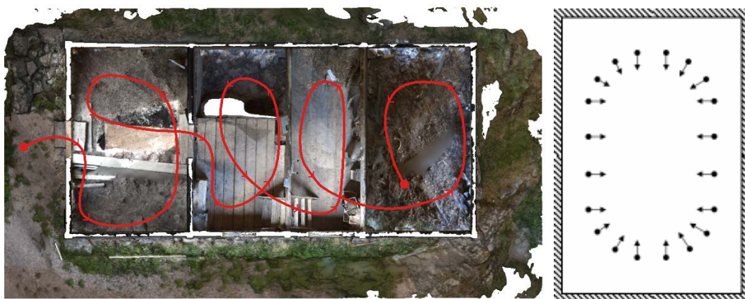
Figuren ovan till vänster visar en grov skiss över tillvägagångssättet vid fotograferandet. Den röda linjen representerar vägen genom byggnaden, in igenom dörren, genom fähuset, den första ladan, över till logen och till sist den östra ladan. Foton togs inte på väggen som var närmast utan tvärt om på den diametralt motsatta väggen (se figuren ovan till höger, hämtad ur manualen till Photo Scan). Detta för att få med mycket rum i varje foto för att på så sätt underlätta programvarans orientering.
