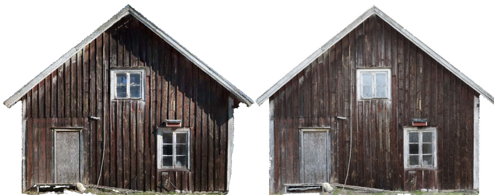
Figuren ovan visar skuggbildningar som uppstår vid skarpt ljus. Figuren ovan består av två olika 3d skanningar, t.v. en baserad på foton tagna i skarpt solsken, t.h. en baserad på foton tagna en molnig dag vilket ger ett väl diffuserat ljus.
