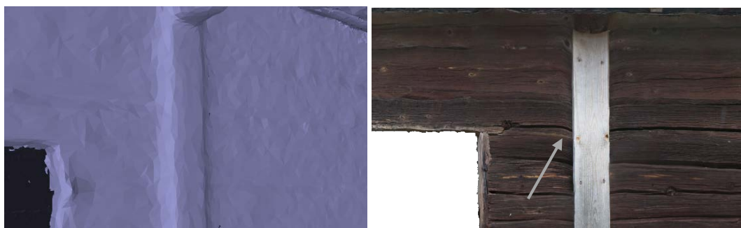
Ovan visas en täckbräda från två något olika vinklar. Bilden till vänster visar polygonstrukturen utan textur, den låga upplösningen gör att kanten mellan timmervägg och täckbräda rundas av. När texturen sedan projiceras över den felaktiga polygonstrukturen uppstår deformationerna synliga till höger.
