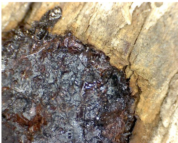
Fig. 27: Bilden visar en spiks korrosion och hur träet bryts ner. Bild: Angelica Fingal
