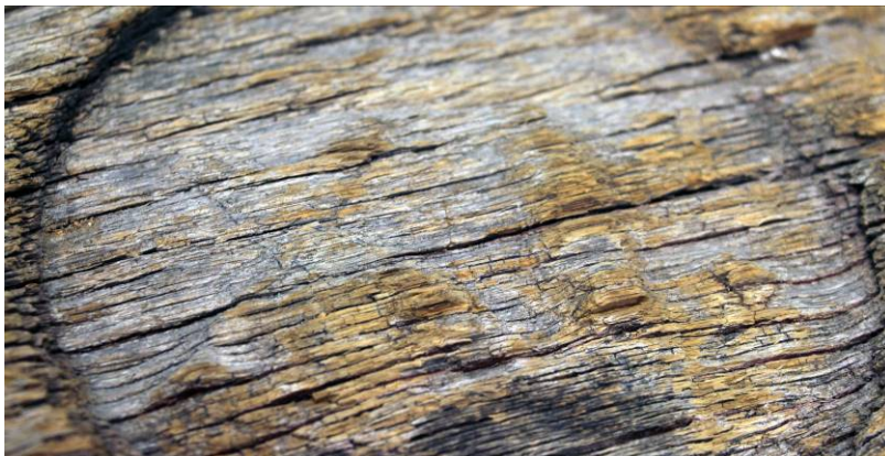
Fig. 25: Bilden visar Karl XI: initialer som knappt är synliga längre. Den gråa ytan har försvunnit vilket resulterat i en gulare träyta. Bild: Angelica Fingal.
