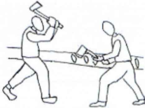
Figur 3. Svallhuggning Bild: ur Eckerman (2011).
