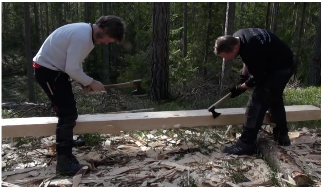
Figur 4. Blockning av timmer på plats i skogen 2014. Foto: Hantverkslaboratoriet
