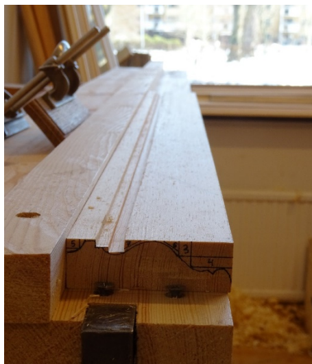
Bild 34. Ploghyveln har använts och de två spåren är gjorda.
