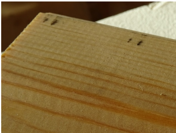
Bild 70. Närbild på maskinhyvlat foder, spår efter kuttern syns som tvärgående räfflor på hela detaljens yta.
