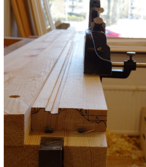
Bild 35. Här används falshyveln till att göra den första falsen, sido-anhåll är inställt men djupet regleras av användaren.
