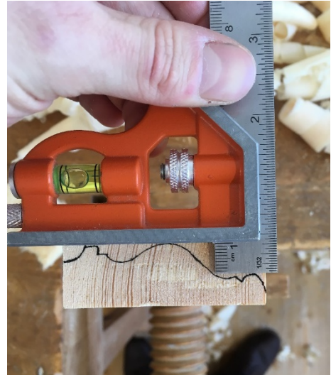
Bild 31. Med hjälp av en justerbar vinkelhake så kan falsar ritas ut på ena änden.
