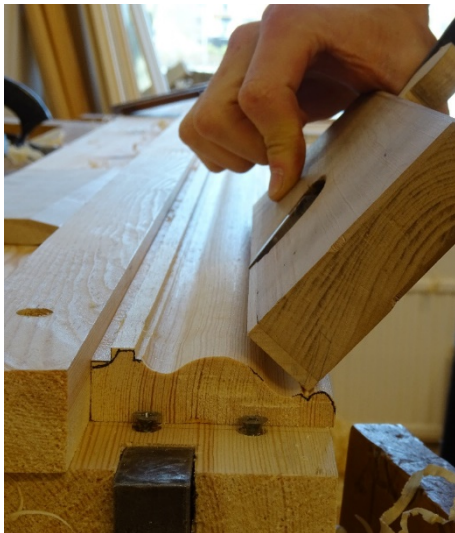
Bild 44. Simshyveln används för att ge ett rakt och tydligt steg in i pärlan.
