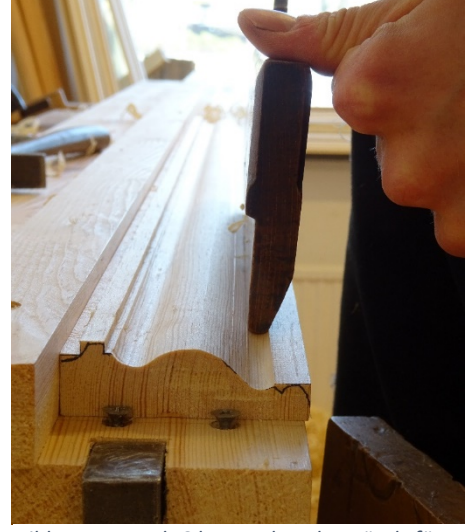
Bild 41. Nr 4 och 6 konvex hyvel används för att hyvla den konkava formen, här är formerna hyvlande på höger och vänster sida om mitten.
