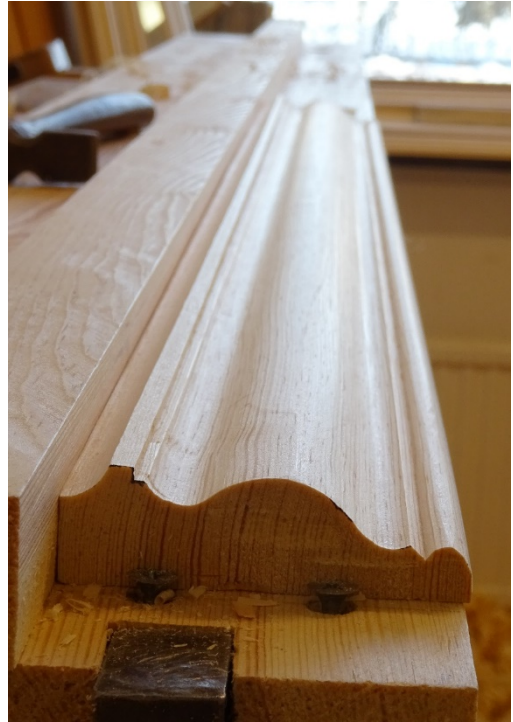
Bild 51. Den färdiga detaljen, efter att ha polerats upp med en näva fint hyvelspån. Sandpapper kan användas för att få bort verktygsspår.
