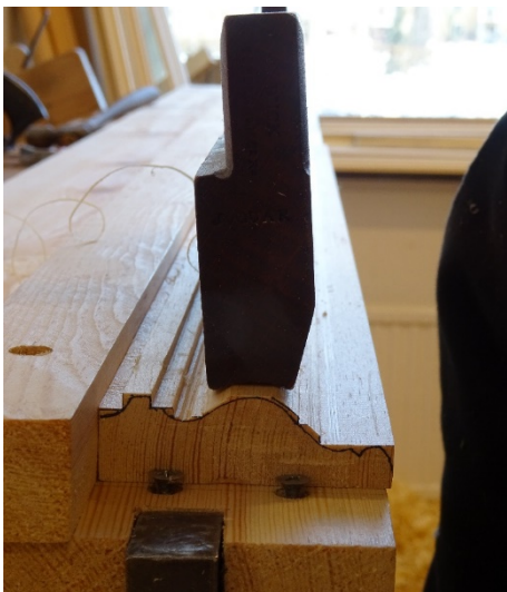
Bild 40. Nr 12 konkav hyvel används för att hyvla den konvexa formen.
