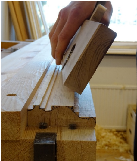
Bild 38. Simshyveln används för att göra faserna på båda sidor av den konvexa delen av karnisen.
