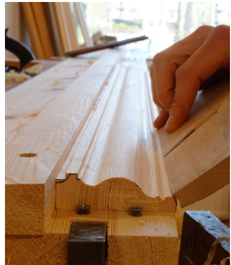
Bild 45. Nr 6 konkav hyveln används för att hyvla utsidan på pärlan.
