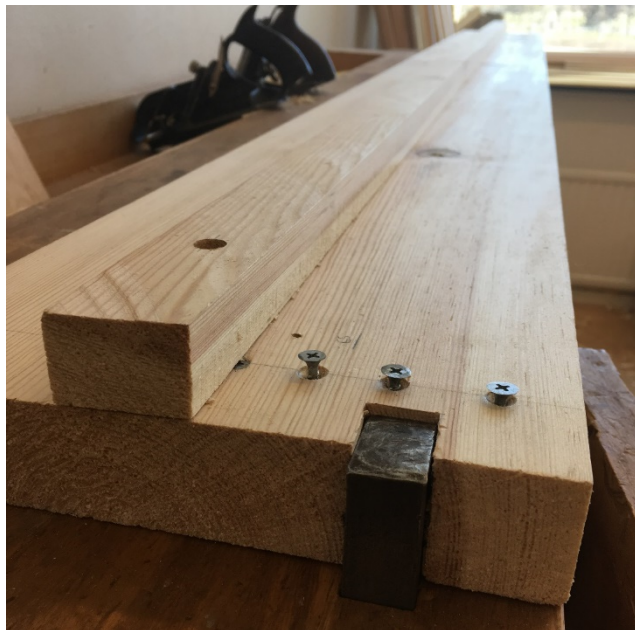
Bild 22. Hyvelbrädan fastspänd på hyvelbänken. Hålet uppe på anhållet leder till en av de tre skruvar som håller fast det justerbara anhållet.
