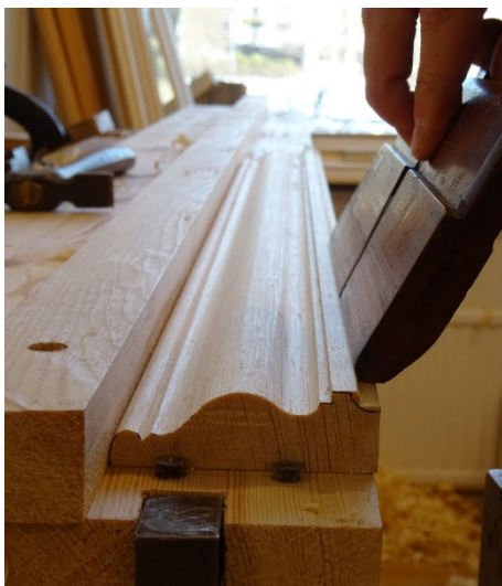
Bild 46. Ämnet vänds och Nr 6 konvex hyvel används för att hyvla hålkälet.
