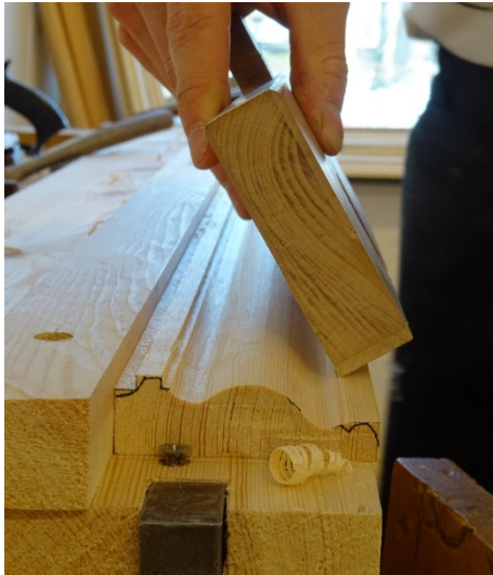
Bild 42. Steget för pärlan etableras med simshyvelns hörn. En djup rits vägleder första hyveltaget.
