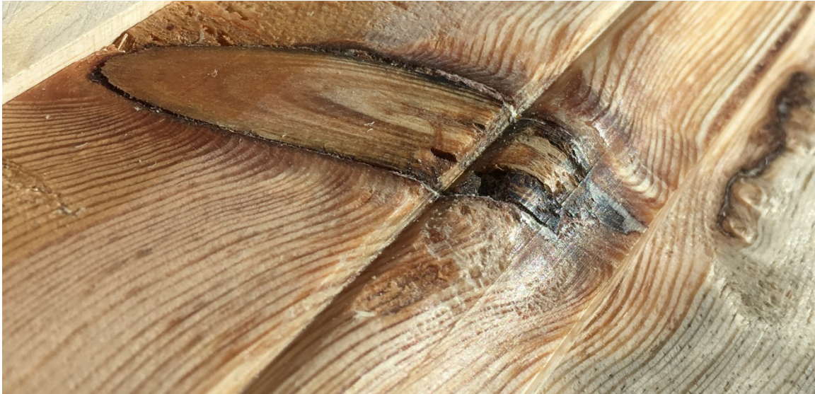
Bild 28. Närbild på en stor kvist mitt i en färdighyvlade profil 3. Kvistar bör alltid undvikas, även om det ibland inte går. Urslag syns på ena sidan av karnisen, där fiberriktningen var "fel". Notera spåret mitt i karnisen, något som varken syns efter eller före kvisten.
