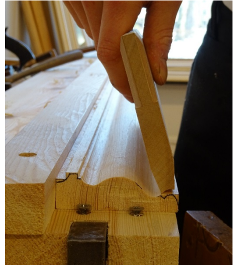
Bild 43. Nr 4 konkav hyvel används för att hyvla insidan av pärlan, vägled av simshyveln.
