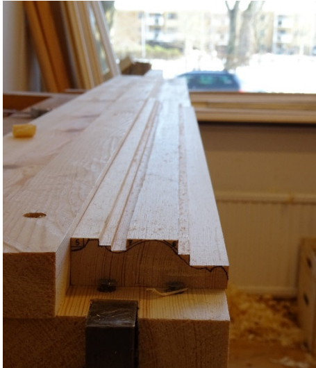
Bild 36. De två första falsarna är gjorda.
