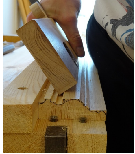
Bild 39. Man får akta hörnet på simshyveln när man hyvlar fasen, då det är lätt att lämna spår nedanför fasen.
