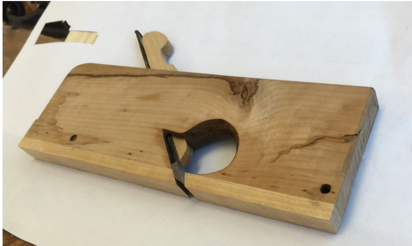
Bild 17. En simshyvel, stålet är centrerat och eggen når ut till båda sidor om hyveln.
