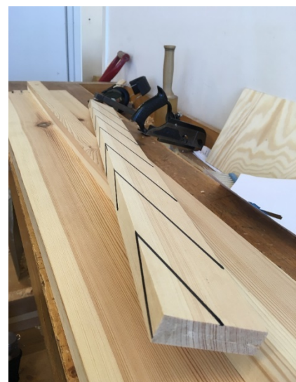
Bild 24. Virkets önskade fiberriktning förstärkt med svart bläck.
