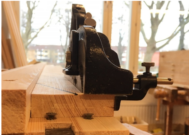
Bild 20. Falshyveln med sina två anhåll. Sidoanhållet till höger och djupanhållet till vänster i bilden.
