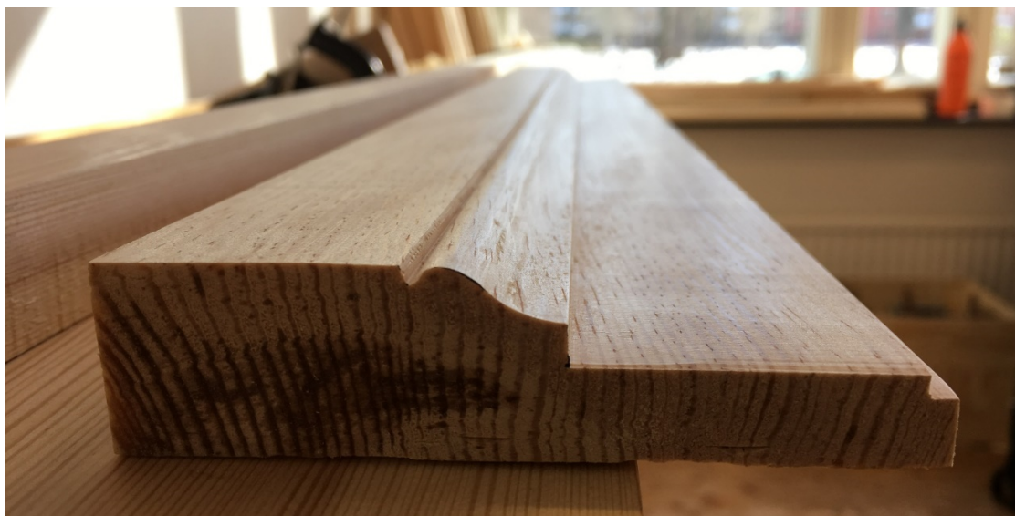
Bild 62. Färdigt foder. En betydligt enklare profil än de tidigare, något som märktes i tidsåtgången.
