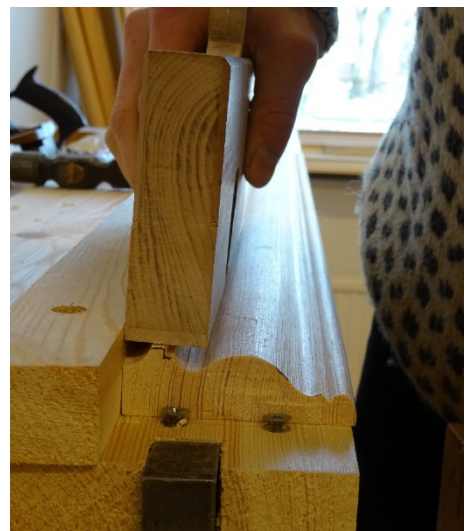
Bild 47. Avslutningsvis används simshyveln för att hyvla ner översta plattan.
