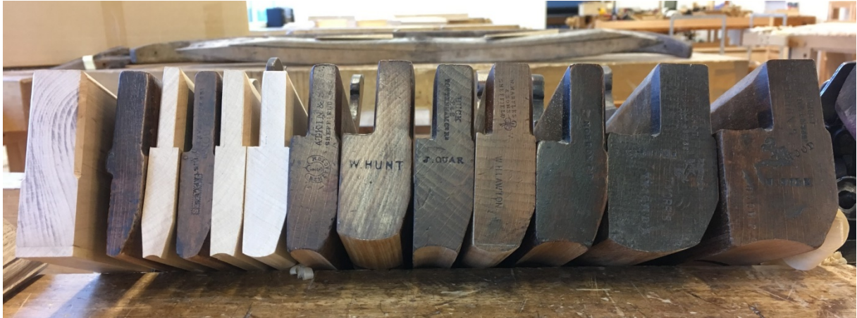
Bild 14. De profilhyvlarna fanns tillgängliga vid arbete. Längst till vänster ses en simshyvel och till höger syns ett par konkava och konvexa hyvlar av nummer 18, som inte användes i detta arbete. Notera också de tre ljusa hyvlarna som är nytillverkade.
