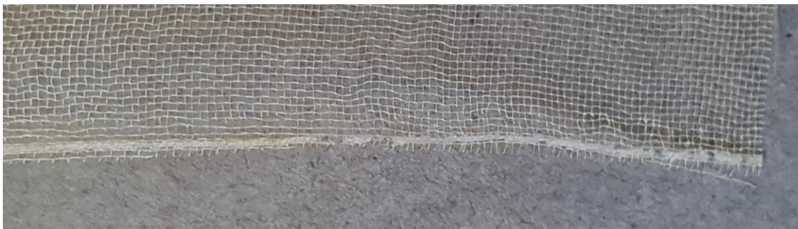
Figur 9. Smält, sträckt polyestertråd på silkescrepelin.
