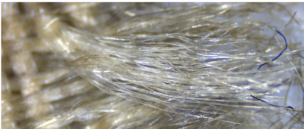
Figur 3. Närbild på vimpeldelens silkesfibrer i mikroskop.
