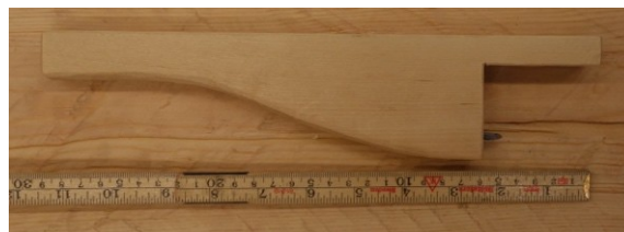
Figur 81 Mått för placering av dubb
