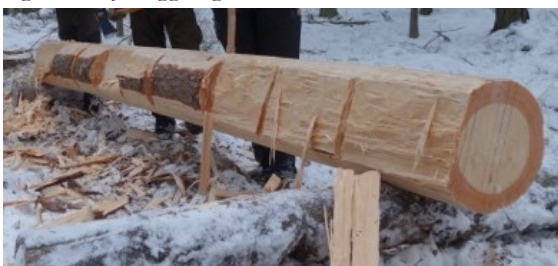
Figur 53 Klamphuggning av stock
