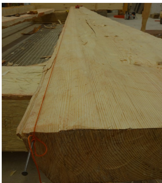
Figur 68 Kontrollering av linje för smalsida
