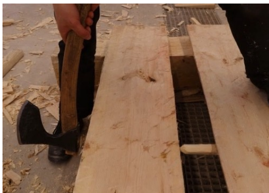
Figurer 86 & 87 Process för uppmärkning av dubbhål
