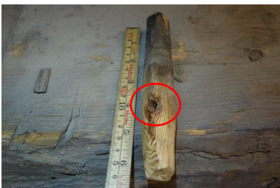
Figur 32 16 cm lång dubb av furu, röd cirkel visar kvisthål
