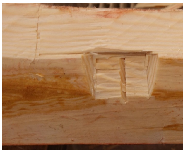
Figur 90 Inhugg med stämjärn å 1 ”
