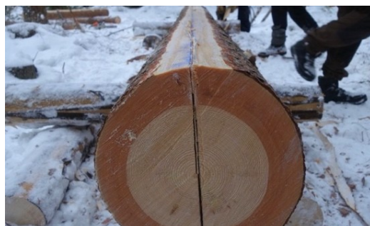
Figur 47 Stocken lodas in och ett streck dras i märgen
