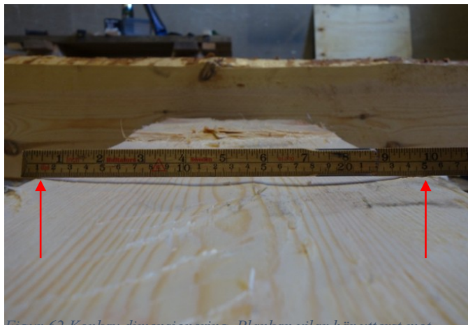
Figur 62 Konkav dimensionering. Plankan vilar här ytterst mot kanterna
