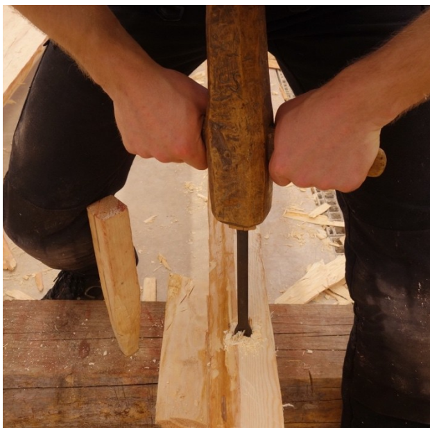
Figur 91 Borrning med skednavare å 1 "
