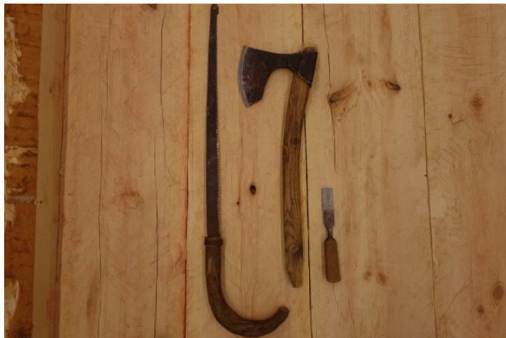
Figur 44 Skärande verktyg fr. vänster: Golvsåg, skrädbila och stämjärn å 1 ”
