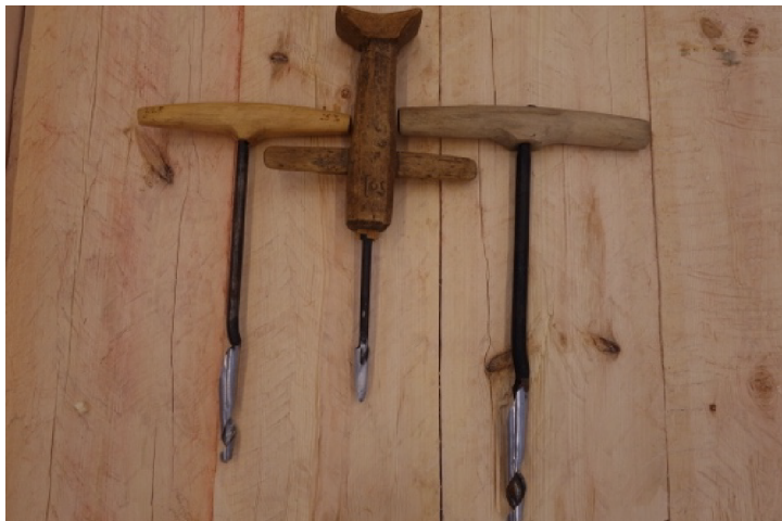
Figur 43: Navare fr. vänster: Konisk spiralnavare 1 ¼ ”, konisk skednavare 1 ” & konisk spiralnavare 1 ½ ”
