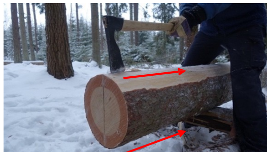
Figur 48 En anvisning görs med yxan
