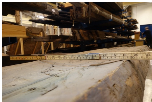
Figur 25 Konkav huggen undersida där plankan vilar i mötet mellan smalsida och undersida
