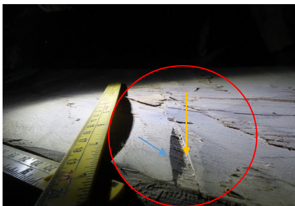
Figur 15 Spår från skyrhuggning på undersidan, gul pil visar kapade hugg i 90° och blå pil visar hugg i 45°
