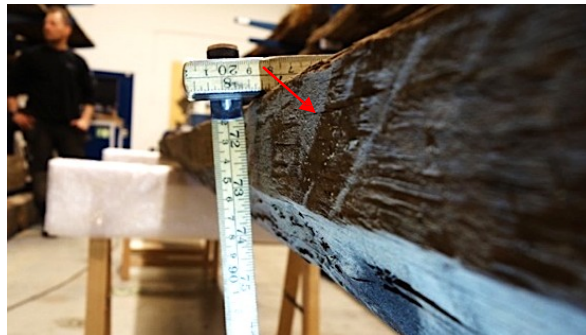
Figur 27 Smalsidan är huggen ur vinkel. Röd pil visar yxans huggriktning
