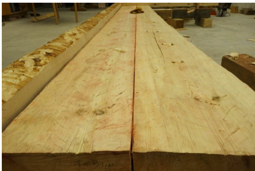
Figur 72 golvplankor huggna efter rak linje
