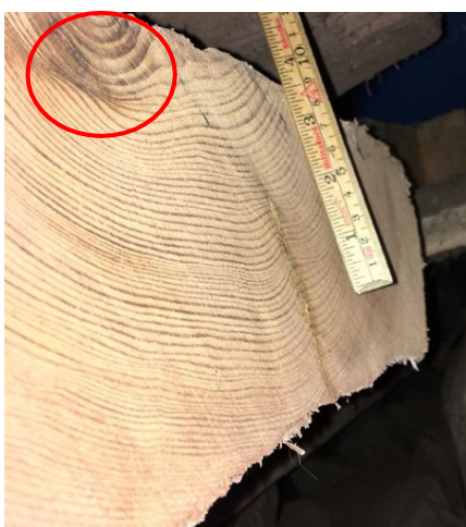
Figur 13 Ändkap gjort vid dendrokronologis datering, notera att plankan troligen är mittklyvd (röd cirkel)
