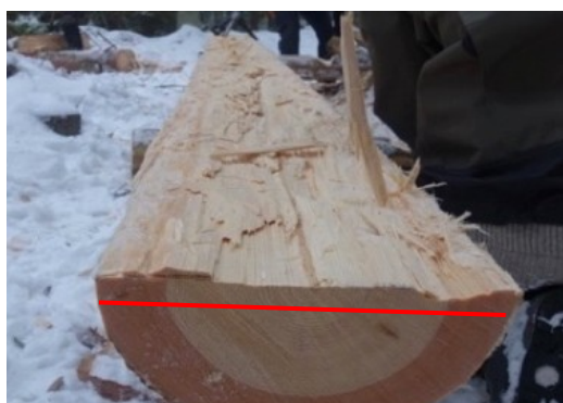
Figur 50 Slutmått på halvklova
