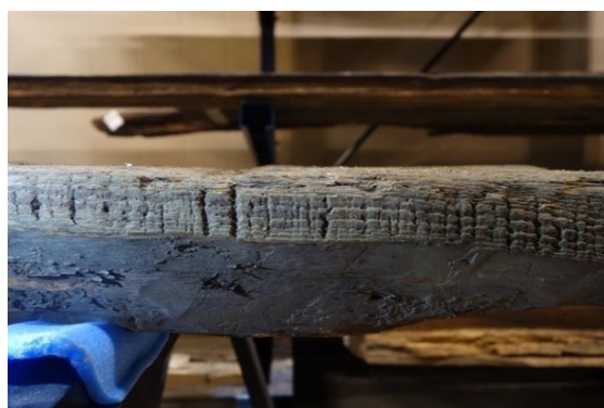
Figur 35 Verktgsspår från sågning
