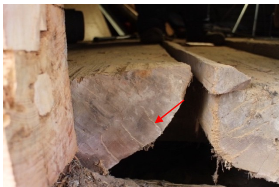
Figur 12 Ändkap på halvklova. Röd pil visar yxans riktning. Bilden är tagen vid annat tillfälle. Foto Kalle Melin
