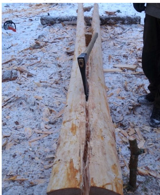
Figur 54 Märgklyvning med spårning där yxan skär av fibrer
