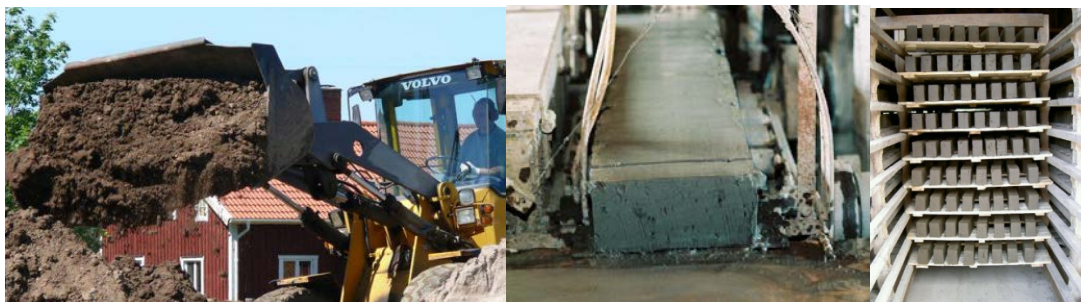
Figur 16 visar utvinning, pressning och torkning av lerblock. Bilder hämtade från Horns tegelbruks hemsida april 2018.
