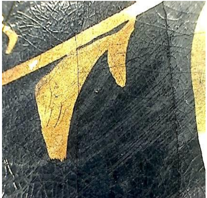
Fig. 9. Närbild på krackelering av svart lack. Bilden är tagen med mikroskop. Foto: Lovisa Henriksson.
