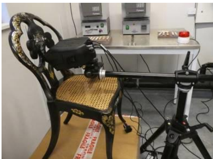
Fig. 17. XRF-instrumentet Elios under provtagning. Utförare: Jacob Thomas. Foto: Lovisa Henriksson.
