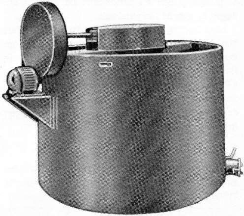
Figur 7. En mindre släckare med maskinell omrörning. Enligt Bährner är det viktigt för kalkens släckning att god kontakt mellan vatten och kalk skapas. Han skriver att det sker bäst i släckare med maskinell omrörning. Vid släckningen sönderfaller kalken under intensiv värmeutveckling. För att temperaturen inte skall bli för hög tillsätts succesivt vatten under omrörning. Lämplig släckningstemperatur är strax under vattnets kokpunkt. När värmeutvecklingen upphört omrörs och späds kalkdegen med vatten till homogen tunnflytande konsistens. Detta för att genom sikt med 1-2 mm fri maskvidd kunna sila och avskilja små klumpar av osläckt kalk. Bild ur Handbok om Murbruk och Putsbruk , Bährner 1966, kap. 2 s. 5.
