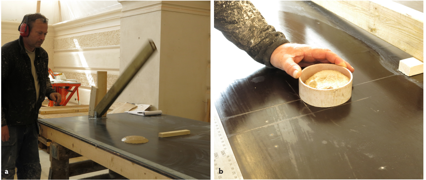
Figur 7a -7d, Göteborgs universitets verksamhets lokaler i Mariestad. Figur 7a visar ett bord avvägt i våg, på bordet är en regel monterad (A), regeln är ledad så att den kan lyftas mot ett anhåll (B). Från anhållet släpps regeln och träffar ett anslag i form av en läkt (C). Läkten är monterad i linje med centrum av var bruket placeras på bordet. I figur 7b placeras bruket på utmärkt plats med hjälp av en cylinder (D) som fylls med bruk.
