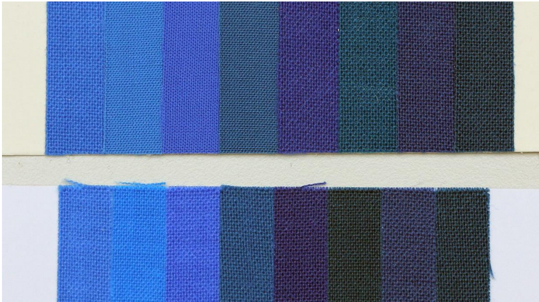
Figur 5. Karta med Blue Wool Standard 1-8 från två olika tillverkare. Den övre från "James Heal" och den undre från Talas. Den senare är en amerikansk leverantör men förser även den europeiska marknaden med material. På bilden syns tydligt att både färg och struktur kan skilja åt.
