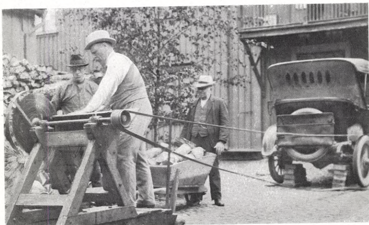
Foto: Torin, Allingsås. Kliché: Aug. Sjöbergs Klichéanst., Gbg. EN PRAKTISK ALINGSÅSBO SOM UTNYTTJAR SIN AUTOMOBIL ÄVEN TILL ANNAN än till åkning. Bilmotorn får driva en cirkelsåg med vilken han sågar sin ved för vintern.
