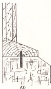
Fig. 30. Spröjsfäste i syllstock å betongmur
