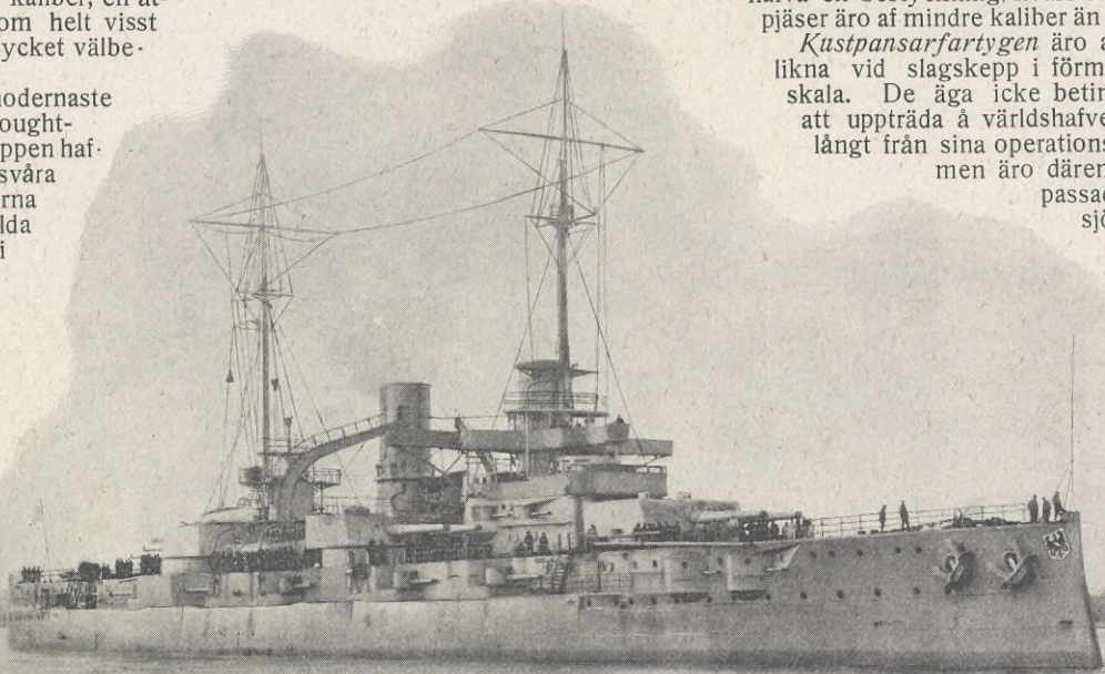
Efter fotograf. TYSKA SLAGSKEPPET RHEINLAND, AF DREADNOUGHT-TYP, 18,500 TON, 20 KNOP; 12 st. 28 cm., 12 st. 15 cm. och 16 st. 8,5 cm. kanoner; 6 st. undervattens-torpedtuber; vattenpansar: 250 mm.
